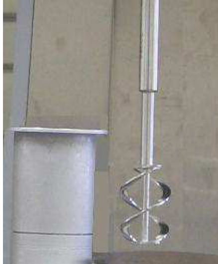
Figure VI.8 : Géométrie double hélices avec son récipient
