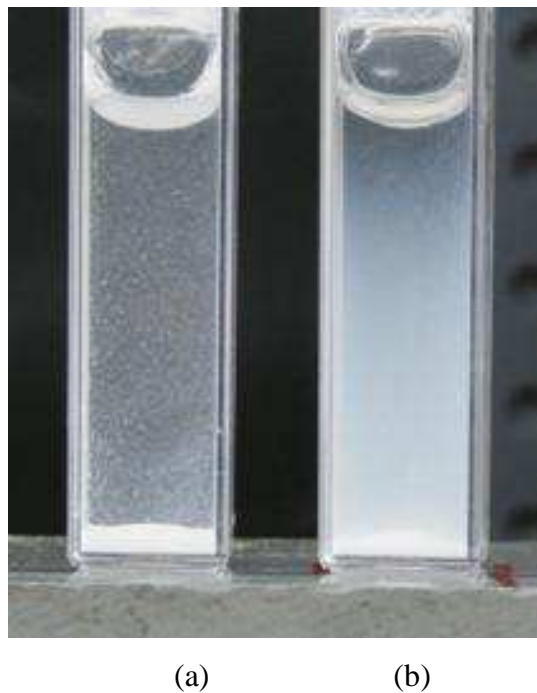
Figure V.1 : Cellules de sédimentation de microparticules adjuvantés ou non, (a) Sans adjuvant, (b) Adjuvantée en OPTIMA100
