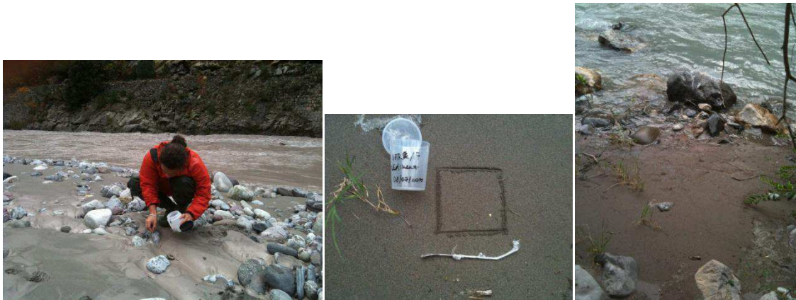
Figure 2.3 : Prélèvement de sédiments de lit de rivière après une crue. En bord de Tinée (à gauche) puis du Var.
