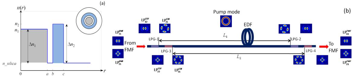
Fig.1. (a) Section transverse de la fibre et profil d'indice de la fibre amplificatrice, la zone dopée est colorée en bleu, (b) représentation schématique du couplage et de l'amplification modale.
