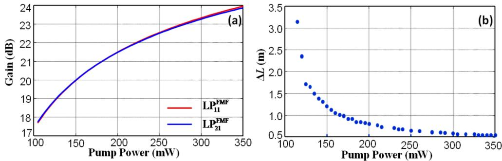
Fig.3. (a) Variation du gain avec la puissance de la pompe pour  $L_1 = 17,8\text{ m}$  (groupe de mode  $LP_{11}$ ) et  $L_2 = 16,6\text{ m}$  (groupe de mode  $LP_{21}$ ). Le gain et la DMG sont respectivement de  $20\text{ dB}$  et  $0\text{ dB}$  à  $150\text{ mW}$ . (b) Différence des longueurs d'amplification ( $\Delta L$ ) en fonction de la puissance de la pompe pour obtenir une DMG nulle et  $20\text{ dB}$  de gain.
