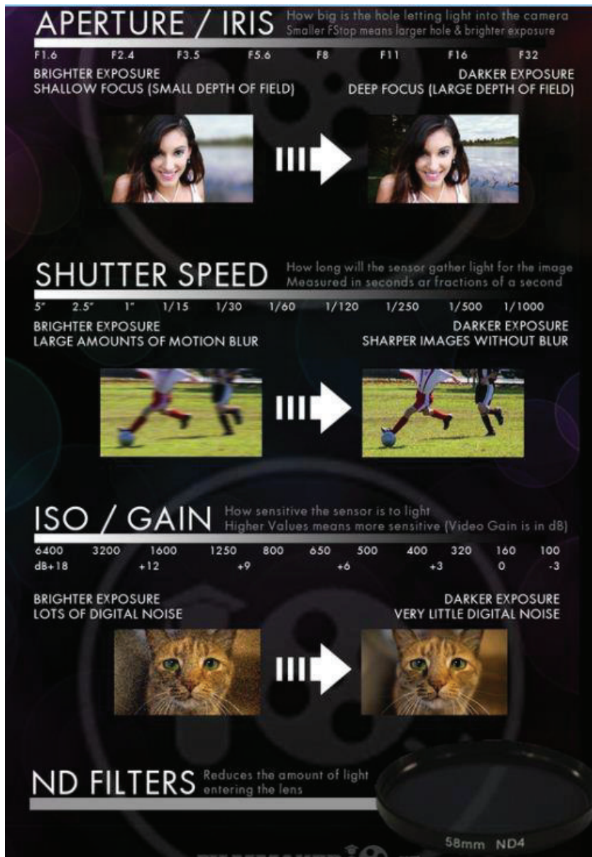
Figure 54 : Visualisation des différents paramètres à régler : focale, vitesse d'obturation, sensibilité ISO sur les appareils Reflex et leur impact sur leurs modifications
