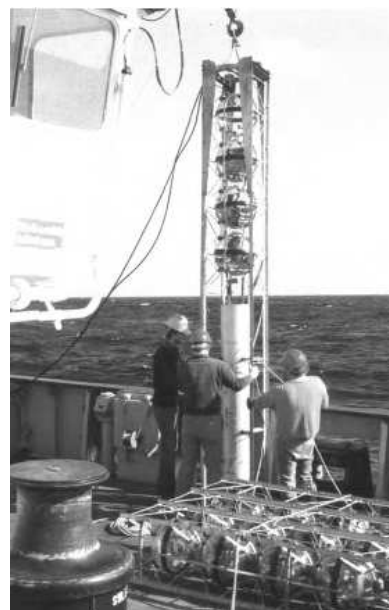
FIG. 2.11 – Un flotteur SOFAR profond. Photographie John Gould.
