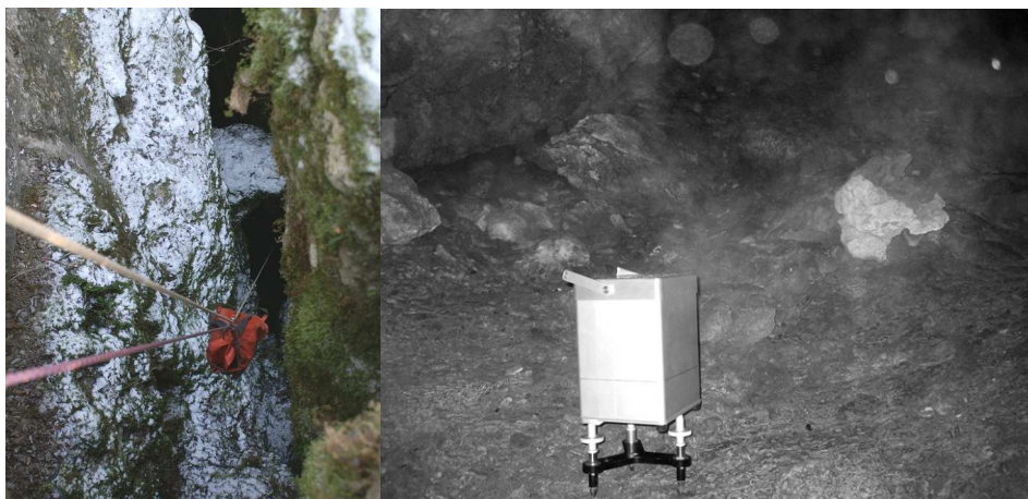
Figure 6.1 gauche : descente du Scintrex CG-5 vers le fond de l'aven de La Beaumelle, droite : instrument en station au fond de l'aven.
