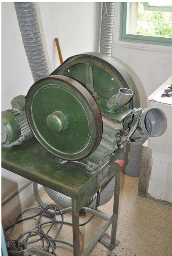
Figure A.1 - Broyeur à mâchoires
