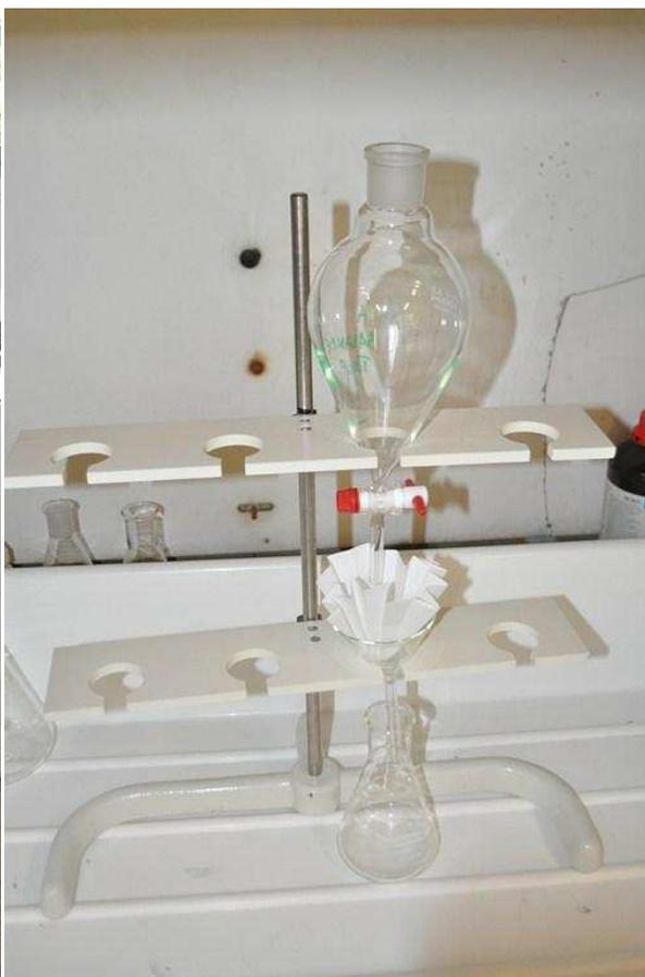
Figure A.2 – Ampoule de séparation par densité
