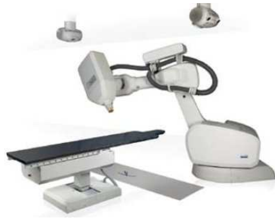
FIGURE 1.6 – Le système robotisé Cyberknife (Accuray).
