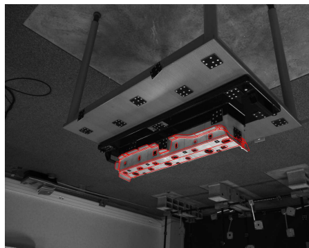
FIG. C.7 – Erreur de reprojection du meilleur recalage de l'étalon. Chaque ligne d'images correspond à une méthode différente. L'image de gauche correspond à la reprojection du modèle CAO et l'image de droite représente l'erreur de reprojection associée (en pixels).
