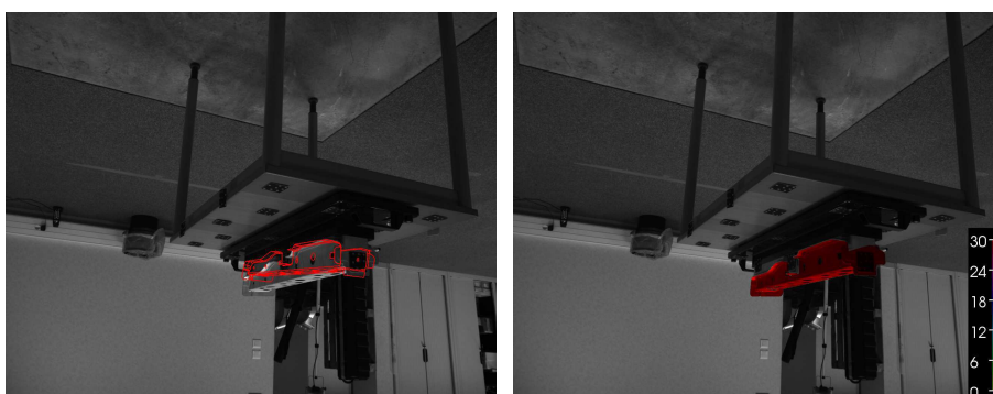
FIG. C.10 – Erreur de position 3D des points de surface du plus mauvais recalage de l'étalon. Chaque ligne d'images correspond à une méthode différente. L'image de gauche correspond à la reprojection du modèle CAO et l'image de droite représente l'erreur de position 3D des points de surface (en mm).
