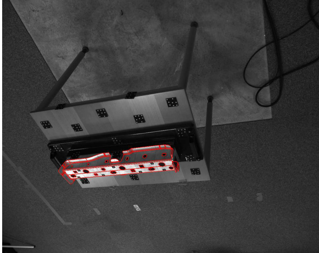
FIG. C.16 – Reprojection du modèle de l'étalon pour un recalage moyen selon la méthode 3D/2D.
