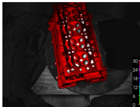
FIG. C.29 – Erreur de position 3D des points de surface du plus mauvais recalage de la culasse. Chaque ligne d'images correspond à une méthode différente. L'image de gauche correspond à la reprojection du modèle CAO et l'image de droite représente l'erreur de position 3D des points de surface (en mm).
