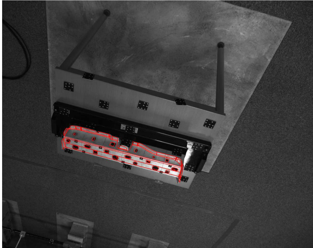
FIG. C.19 – Reprojection du modèle de l'étalon pour un recalage moyen selon la méthode 3D/3D.
