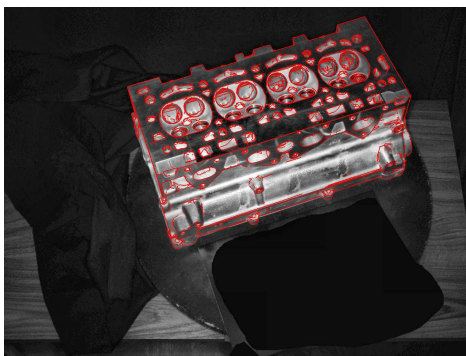
FIG. C.27 – Erreur de position 3D des points de surface du meilleur recalage de la culasse. Chaque ligne d'images correspond à une méthode différente. L'image de gauche correspond à la reprojection du modèle CAO et l'image de droite représente l'erreur de position 3D des points de surface (en mm).
