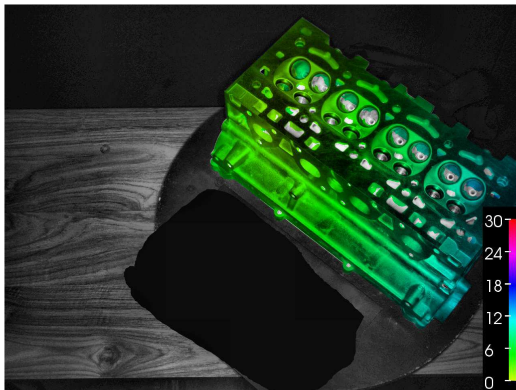
FIG. C.40 – Erreur de position des points de surface de la culasse pour un recalage moyen selon la méthode 3D/3D. L'échelle est donnée en mm.
