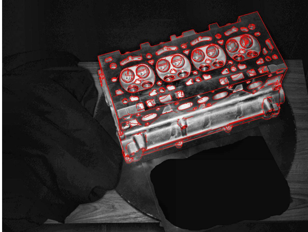
FIG. C.35 – Reprojection du modèle de la culasse pour un recalage moyen selon la méthode 3D/2D.
