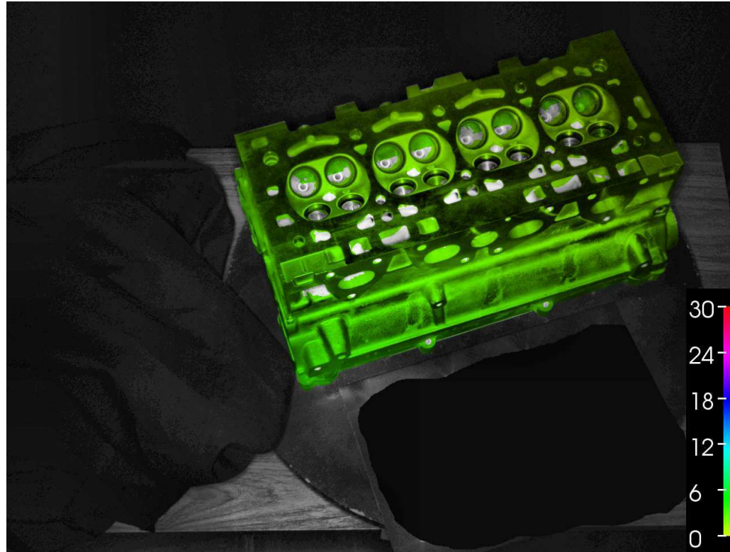
FIG. C.37 – Erreur de position des points de surface de la culasse pour un recalage moyen selon la méthode 3D/2D. L'échelle est donnée en mm.
