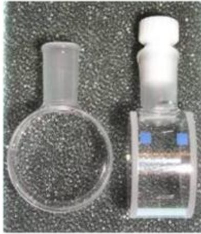
figure III.4_ ampoule « camembert » utilisée pour la dosimétrie de Fricke
