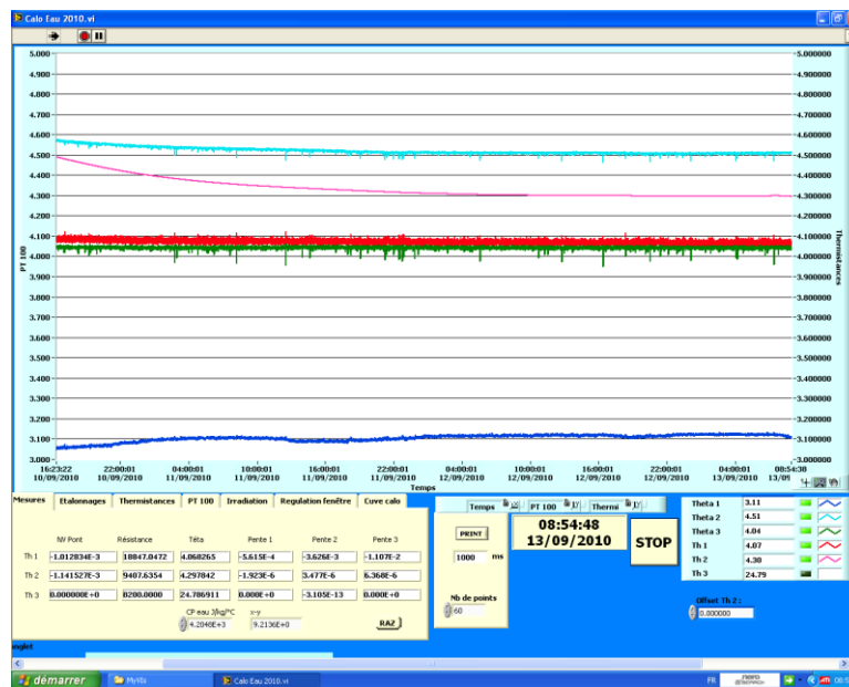
Figure 58: Représentation graphique du suivi de la température par les sondes. En rose la température à l'intérieur de l'ampoule ; en bleu foncé la température de l'air sous la cuve ; en vert la température de l'air dans la fenêtre d'entrée ; en rouge la température dans l'enceinte au dessus de la fenêtre d'entrée ; et en cyan la température dans l'enceinte au dessus de la cuve.
