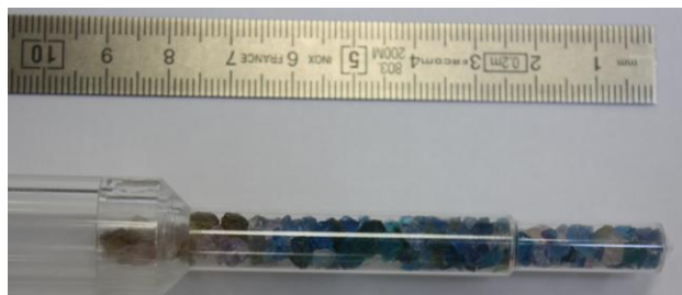
Figure 25 : Capot d'étanchéité en PMMA pour la chambre d'ionisation NE2571.
