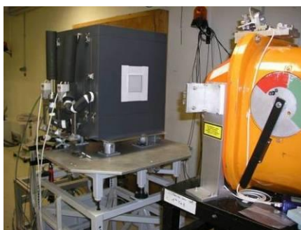
Figure 61: Calorimètre eau face au faisceau de ^{60}\text{Co} n°2C du LNHB.
