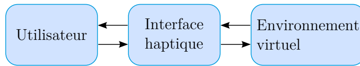
Figure 1.6 – Architecture d'un environnement avec rendu haptique en admittance
