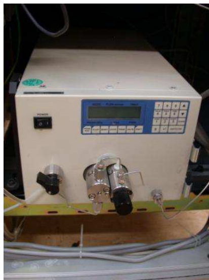
Photographie III-3 : Pompe HPLC Jasco PU-2080 utilisée dans le montage haute température / haute pression.
