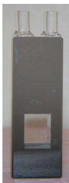
Photographie III-13 : Cellule optique d'irradiation à circulation utilisée lors de la radiolyse stationnaire à température ambiante. Trajet optique : 9 mm.
