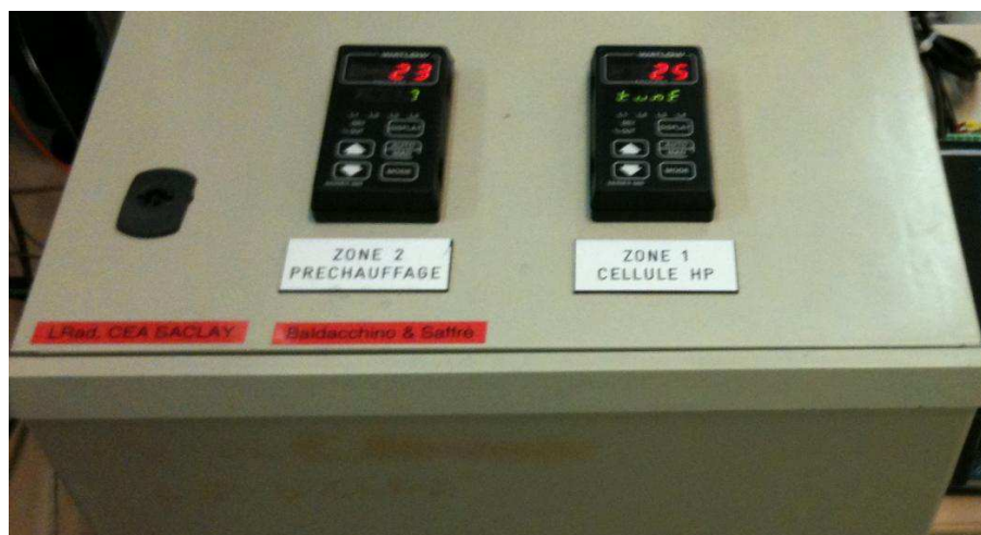
Photographie III-8 : Boîtier de régulation de température. L'affichage rouge correspond à la température relevée au niveau des thermocouples J situés dans les résistances chauffantes.
