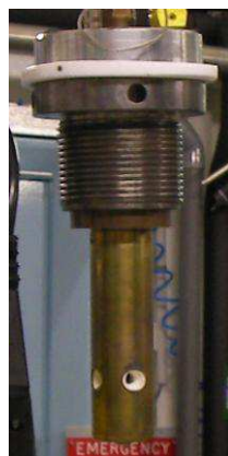
Photographie III-12 : Four interne de l'autoclave sur la ligne de faisceau BM30 de l'ESRF.
