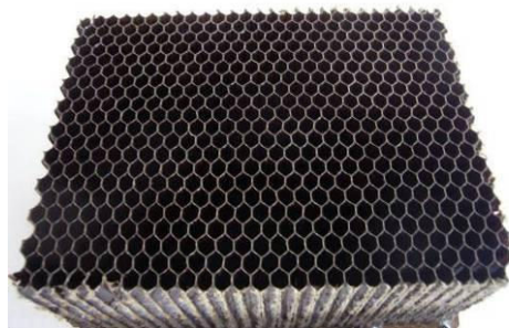
Figure V-1. Matrice aramide ECA-I 144 (Euro-Composites) à structure nid d'abeilles, utilisée pour fabriquer les électrodes positives des réacteurs Pb-AMS.
