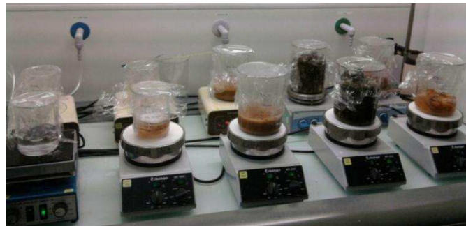
Figure 52 : Aspect général des béchers en fin d'échange labile. Les échanges réalisés dans l'eau de forage sont au premier plan, ceux réalisés dans les « conditions stomacales » sont à l'arrière-plan. De gauche à droite : blanc, pomme de terre, cèdre, feuilles de chêne, pomme.
