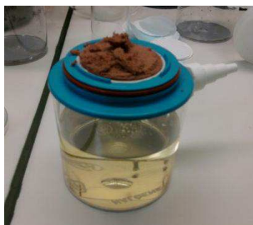
Figure 53 : Unité de filtration (8 \mu\text{m} ) de l'eau d'échange labile du cèdre.
