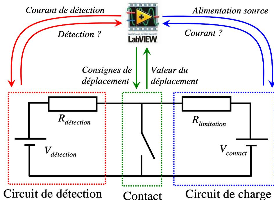
Figure 70 : Pilotage du dispositif de claquage
