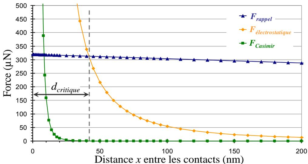
**Figure 154 : Evaluation des forces attractive et répulsive en fonction de la distance entre les contacts pour la structure de relais MEMS actionnée avec le nanoindenteur**
