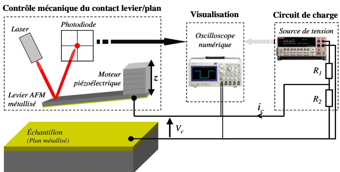
**Figure 62 : Schéma de principe du montage expérimental utilisant l'AFM en mode force**
