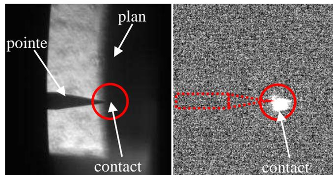
**Figure 131 : Lumière émise par le banc de claquage lors des cycles observées sur la caméra CCD du spectrographe (3min avec  $V_c = -70\text{V}$ , plan Au en anode, vitesse de  $500\text{nm/s}$  et ouverture maximale de  $2\mu\text{m}$ )**
