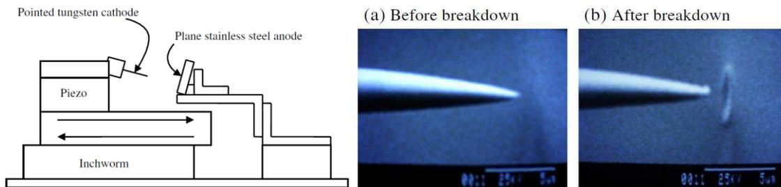
**Figure 41 : Observation in situ au MEB des deux électrodes avant et après claquage électrique [Hira07]**
