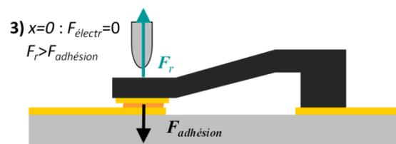
**4)** La réouverture du contact due à la force de rappel de la poutre crée donc le premier rebond. Le contact mobile se trouve alors à une distance inférieure à la distance critique puisque l'actionneur continue de descendre de manière continue. La force électrostatique réapparaît au contact au fur et à mesure que la différence de potentiel au contact augmente.
