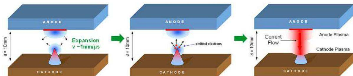
Figure 39 : Mécanisme de transfert de matière dans le vide [Rowe09]
