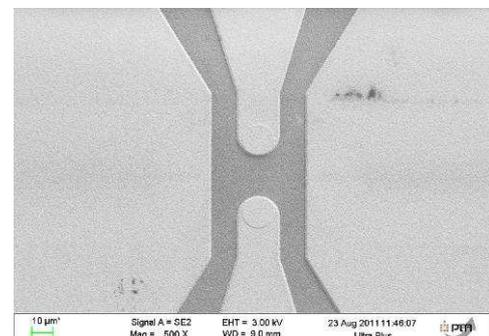
Figure 12 : Vue de dessus par microscopie électronique à balayage (MEB) de la partie fixe du relais LETI
