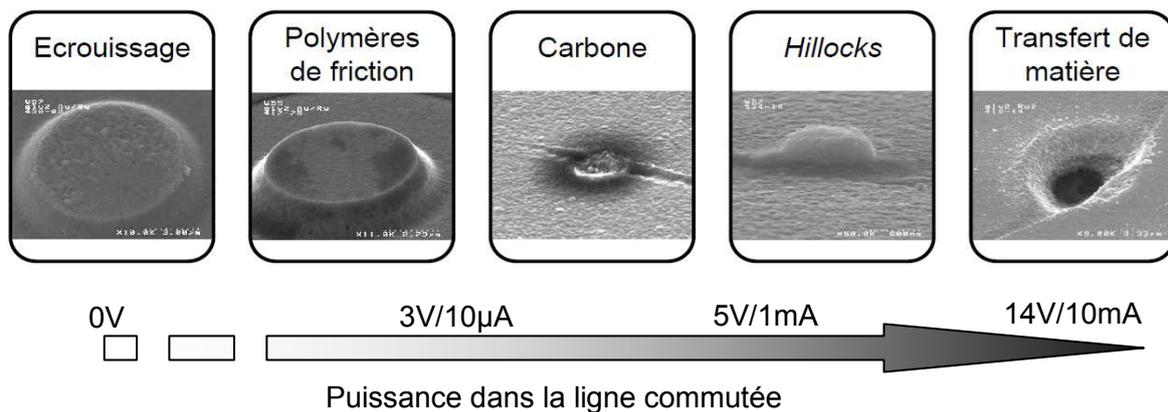
Figure 18 : Mécanismes de défaillance du contact électrique [Vinc10]
