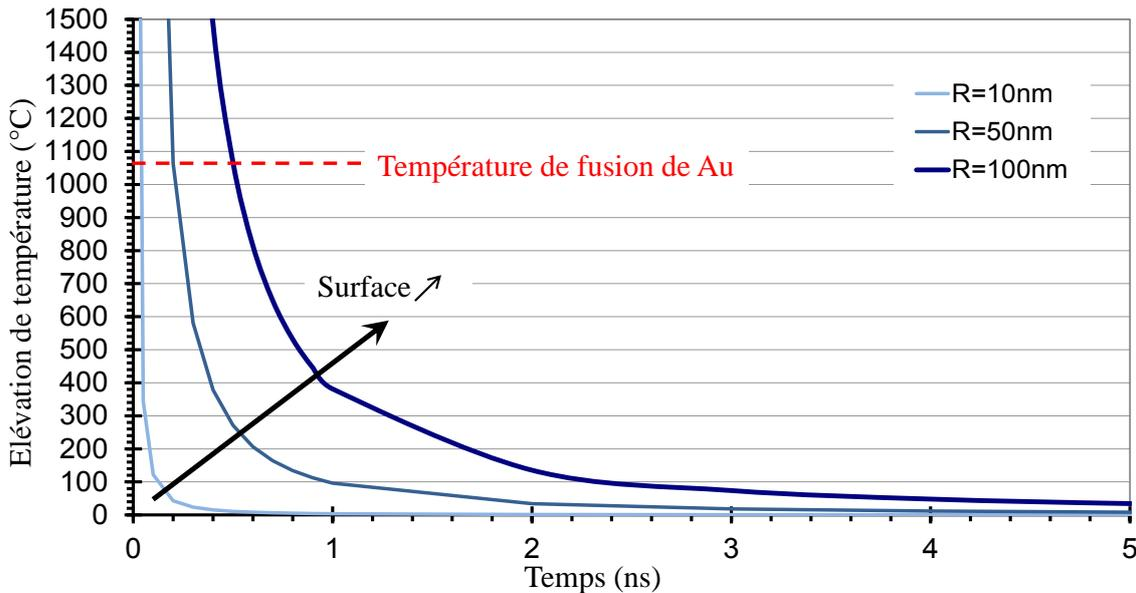
Figure 110 : Elévation de température à la surface du matériau (z=0) calculée d'après (24) ( $q=25.10^{-3} \text{K.m}^{-1}.\text{s}^{-1}$ ,  $k=1,28.10^{-4} \text{m}^2.\text{s}^{-1}$ ,  $R=10\text{nm}$ ,  $z=r=0$ )
