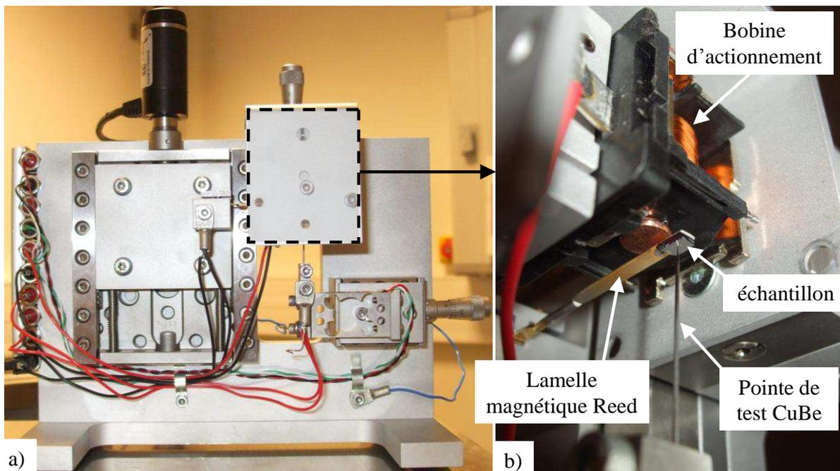
Figure 66 : a) Banc de cyclage et b) détails de la pointe de test et de la lamelle magnétique
