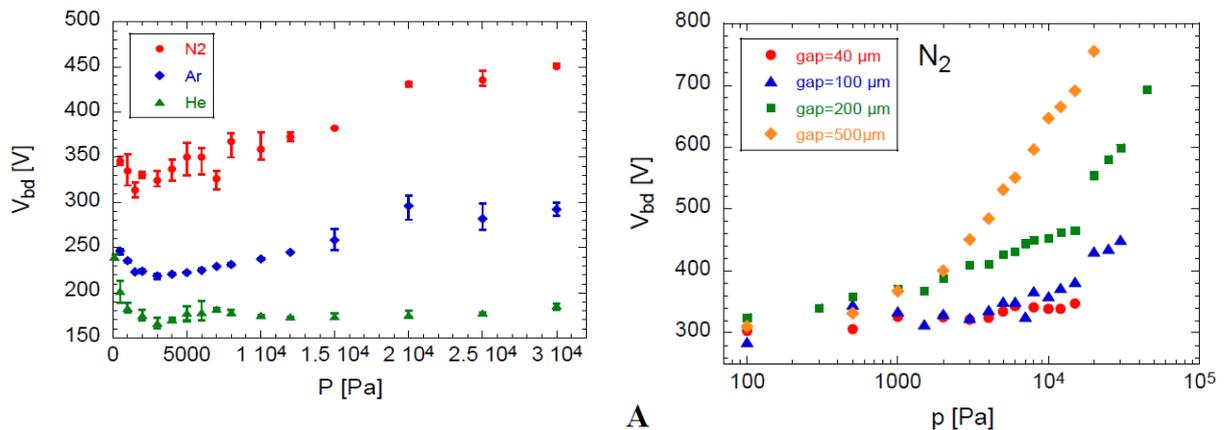
**Figure 40 : Tension de claquage en fonction de la pression :**
