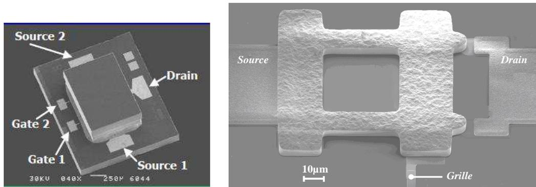
Figure 15 : Description du relais MEMS électrostatique RADANT [Radant]
