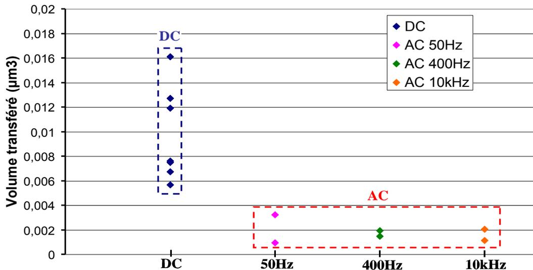
Figure 93 : Comparaison du transfert de matière à la fermeture du contact pour des tensions continues (DC) ou alternatives (AC) (50cycles, contact Au-Au, 10V)
