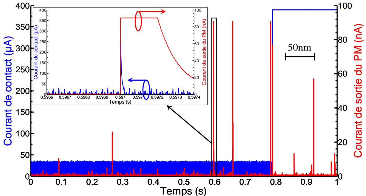
Figure 130 : Emission de lumière observée avec le PM dans les derniers nanomètres avant la fermeture du contact ( $V_c=50V$ ,  $v=500nm/s$ , ouverture max= $3\mu m$ )
