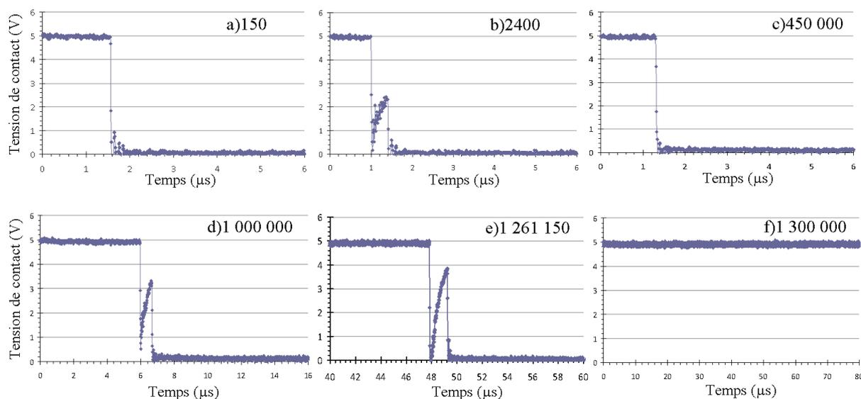
**Figure 136 : Evolution de la tension de contact à la fermeture du relais LETI-1 pour a) 150, b) 2400, c) 450000, d) 1000000, e) 1261150 et f) 1300000 cycles ( $f=2\text{Hz}$ ,  $5\text{V}/500\mu\text{A}$ )**
