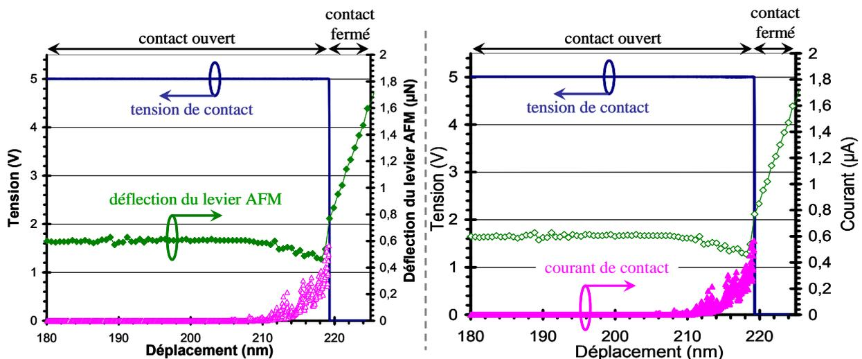
**Figure 100 : Mesure du courant lors de la fermeture du contact avec un AFM (contact Au-Au,  $v=30\text{nm/s}$ ,  $V=5\text{V}$ ,  $i_{max}=100\mu\text{A}$ , levier AFM polarisé en cathode)**
