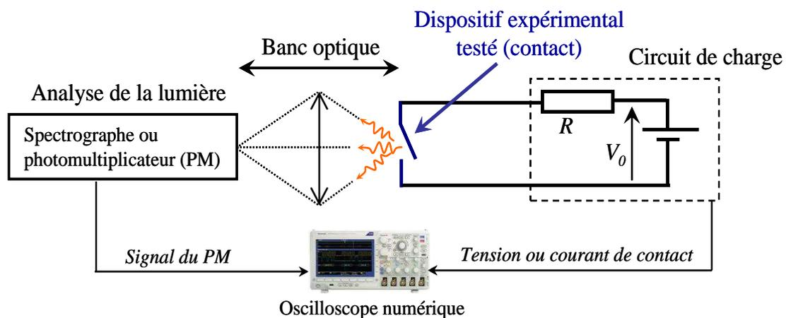
Figure 75 : Schéma de principe des expériences réalisées
