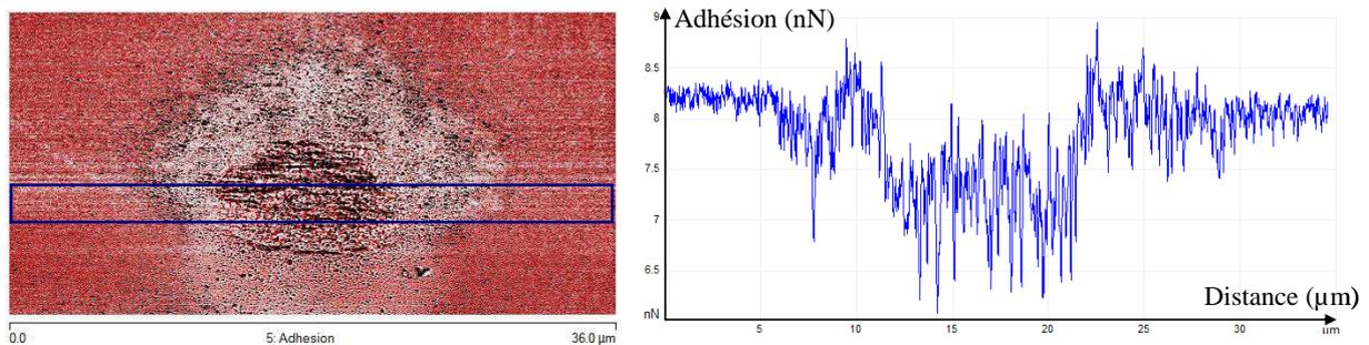
**Figure 98 : Cartographie de l'adhésion de surface au niveau d'un contact endommagé par du transfert de matière**
