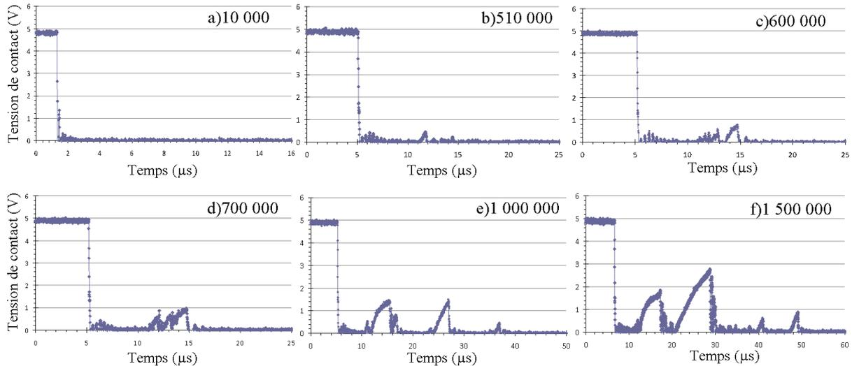
**Figure 137 : Evolution de la tension de contact à la fermeture du relais Omron-1 pour a) 10000, b) 510000, c) 600000, d) 700000, e) 1000000 et f) 1500000 cycles ( $f=2\text{Hz}$ ,  $5\text{V}/500\mu\text{A}$ )**
