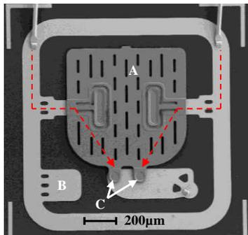
Figure 13 : Vue de dessus du relais magnétique LETI
