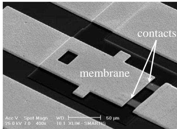
**Figure 4 : Exemple de relais MEMS [Mard08]**
