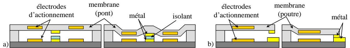
**Figure 5 : Schéma de principe en coupe d'un relais électrostatique :
