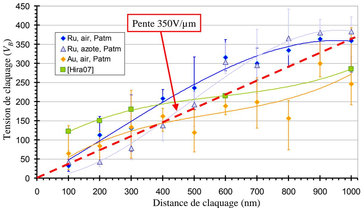
Figure 117 : Comparaison des valeurs expérimentales pour  $d < 1\mu\text{m}$
