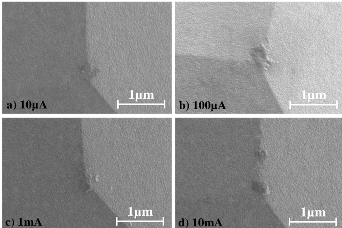
Figure 92 : Evolution du transfert de matière en fonction du courant à la fermeture
