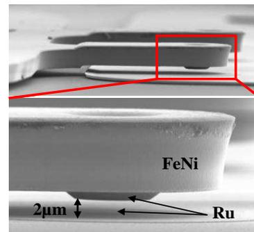
Figure 14 : Vue de côté au MEB des contacts
