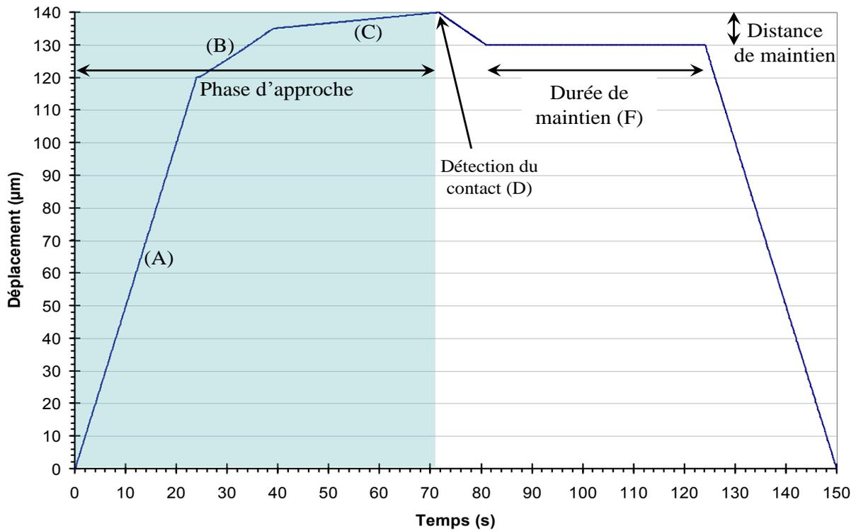
**Figure 72 : Cycle réalisé par la table piézoélectrique**
