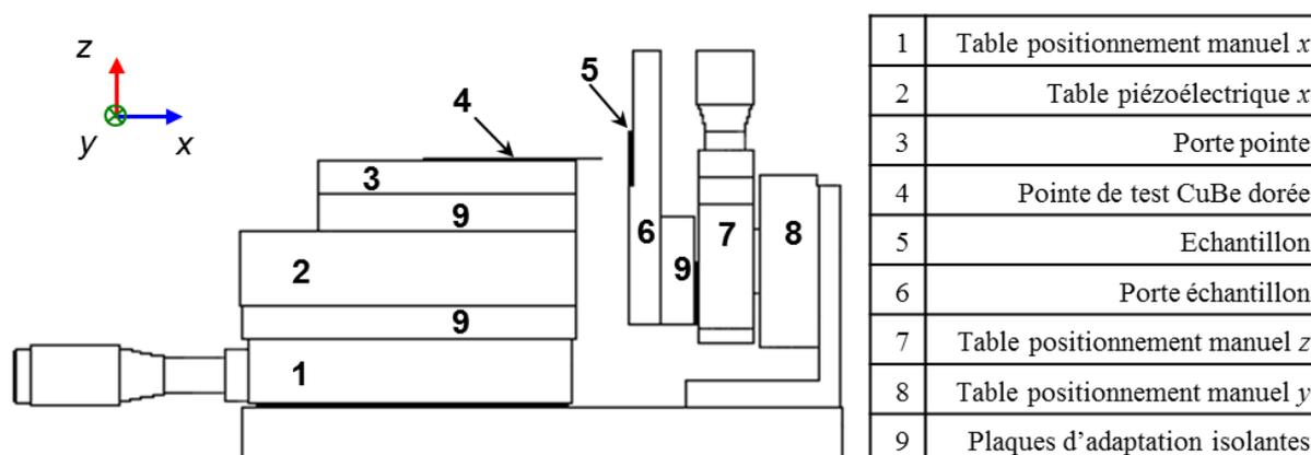
**Figure 68 : Schéma du dispositif de claquage**
