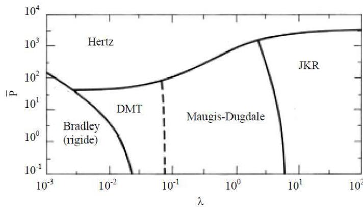
**Figure II.6:** carte d'adhésion pour un contact élastique basé sur le modèle de Maugis. Chaque théorie est applicable dans un intervalle de  $\lambda$  donné. Le modèle de Bradley concerne le contact entre deux sphères rigides indéformables. Pour une charge normale très grande par rapport à la force d'adhésion, la théorie de Hertz est valable partout [Johnson et Greenwood, 1997].
