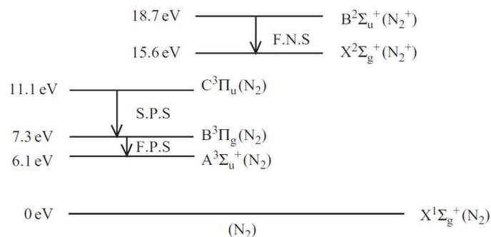
Figure 133 : Diagramme de niveau d'énergie de la molécule d'azote
