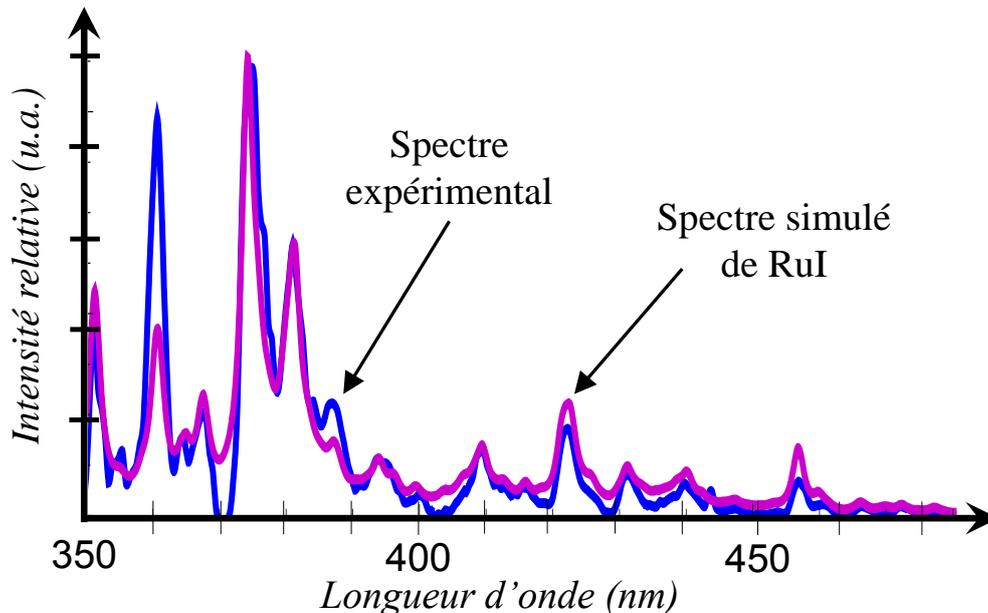
Figure 128 : Spectre expérimental corrigé par la réponse spectrale du détecteur et spectre simulé pour le ruthénium à  $T_{exc}=7600K$
