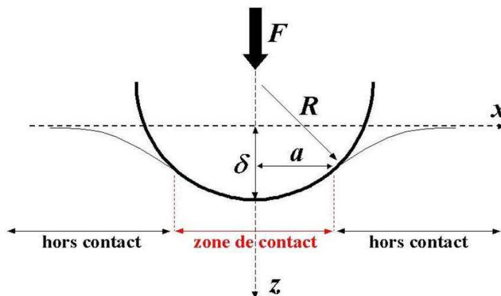
Figure 166: Illustration du contact de Hertz [Arine03]
