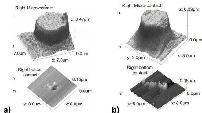
**Figure 42 : Plot de contact après 2000 cycles (à 1Hz) a) 6V DC b) 6V AC [Yang11]**
