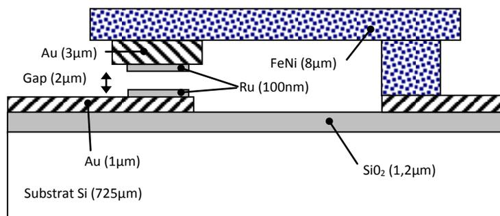
Figure 58 : Représentation schématique du véhicule de test étudié
