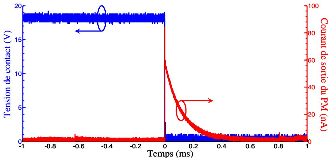
Figure 123 : Observation de lumière au moment de la fermeture du contact avec le banc de cyclage ( $V_c=18V$ ,  $i=3,2mA$ )
