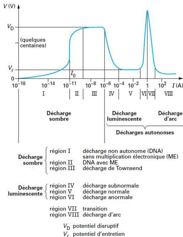
Figure 167 : régimes de décharge à courant continu [TI-D2830]
