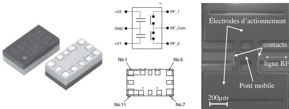
Figure 16 : Description du relais MEMS RF électrostatique OMRON [Omron]
