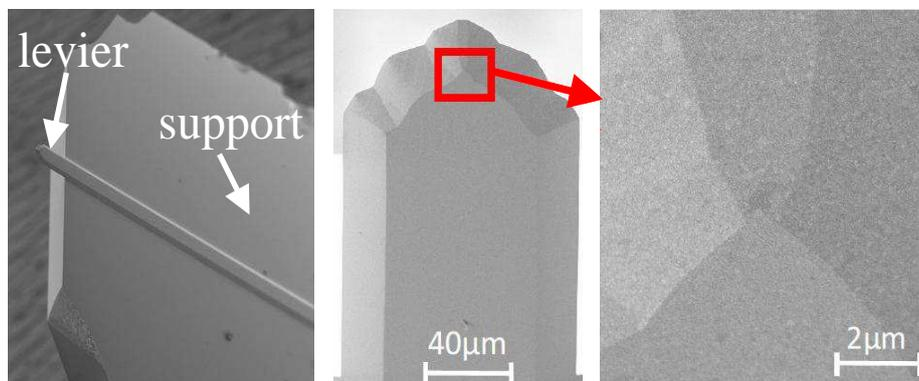
Figure 64 : Images MEB des leviers AFM métallisés (Au) sans pointe à l'état neuf
