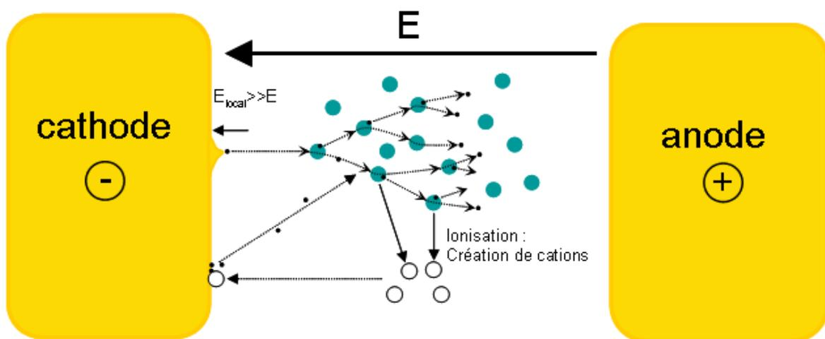
Figure 28 : Illustration du mécanisme d'avalanche électronique
