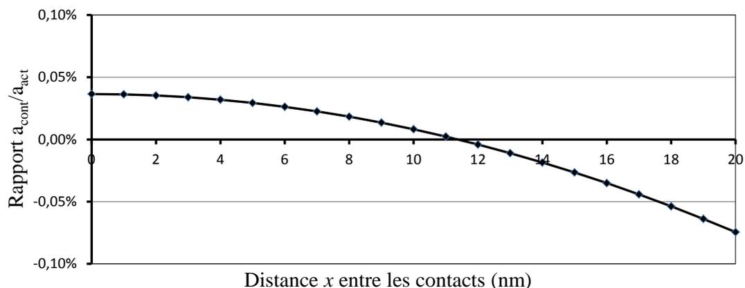
**Figure 156 : Evolution du rapport de l'accélération due aux forces électrostatiques de contact et de l'accélération due aux forces (électrostatiques) d'actionnement en fonction de la distance entre les contacts d'après l'équation (31) et dans le cas simplifié du relais LETI ( $k=140\text{N/m}$ ,  $\epsilon_0=8,85.10^{-12}\text{F/m}$ ,  $d=500\text{nm}$ ,  $S_{cont}=8.10^{-11}\text{m}^2$ ,  $V_{cont}=5\text{V}$ ,  $S_{act}=4.10^{-9}\text{m}^2$ ,  $V_{act}=37\text{V}$ )**
