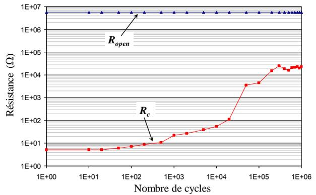
**Figure 80 : Evolution typique de la résistance à l'état fermé ( $R_c$ ) et à l'état ouvert ( $R_{open}$ ) au cours des cycles en « hot switching » pour  $V_c < 5V$  ( $i=100\mu A$ )**
