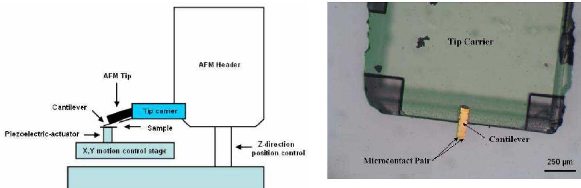
Figure 22 : Technique AFM utilisant directement une poutre de relais MEMS en remplacement du levier AFM [Yang08]
