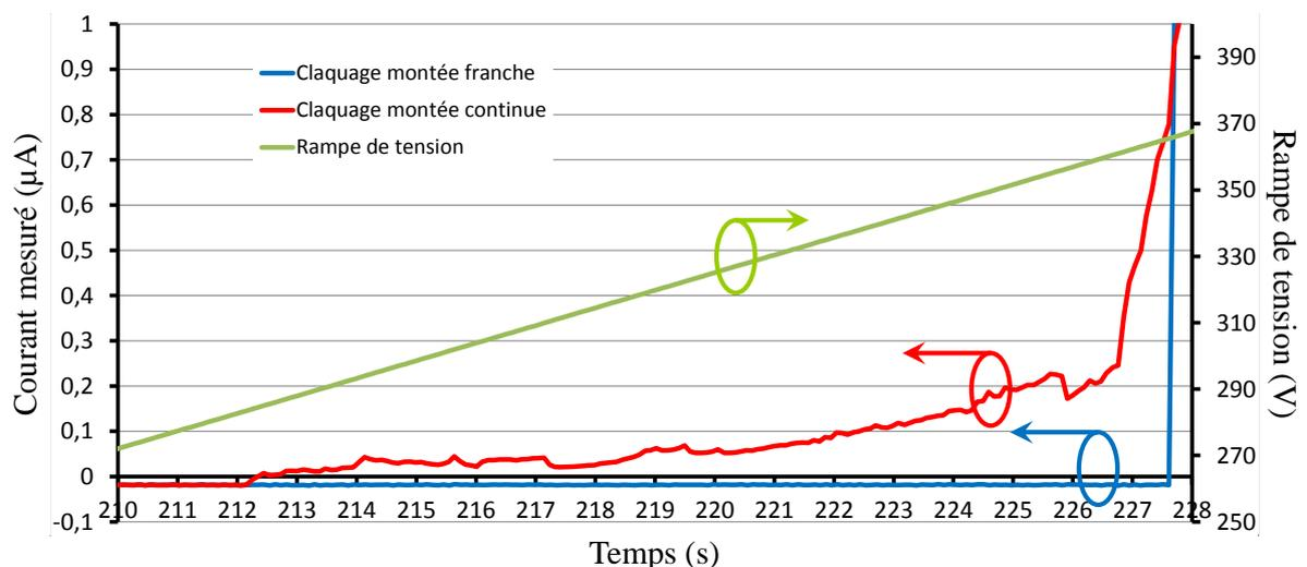
Figure 111 : Evolution typique du courant lors de deux essais ( $d=1\mu\text{m}$ , plan Ru, à  $T_{\text{ambiante}}$ , sous air)
