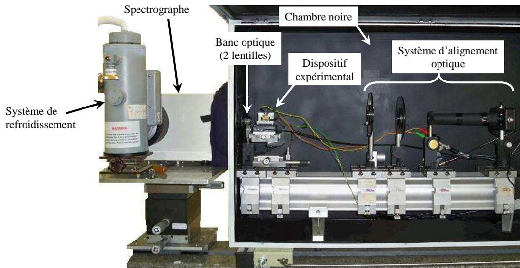
Figure 76 : Photographie du montage expérimental avec le spectrographe
