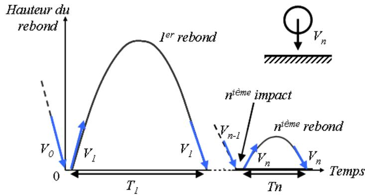
**Figure 45 : Illustration du comportement mécanique lors de l'impact mécanique d'une sphère sur un plan**
