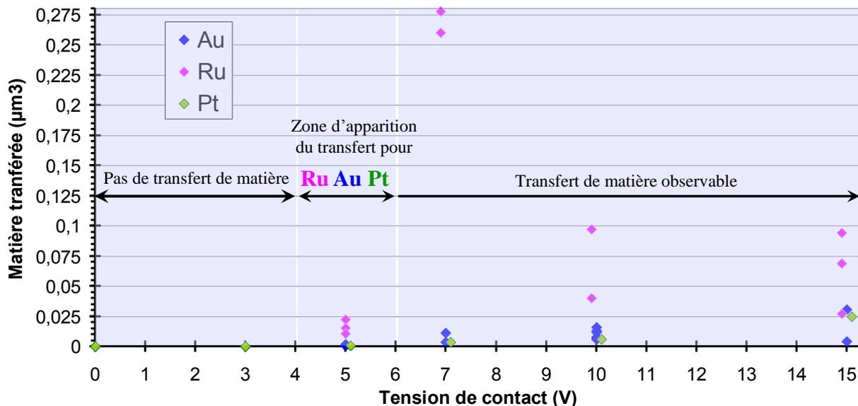
**Figure 94 : Volume de matière transférée à la cathode en fonction de la tension de contact à l'état ouvert pour une anode en or (Au), ruthénium (Ru) ou platine (Pt) ( $i=100\mu\text{A}$ , 50 cycles à 30nm/s, levier AFM Au en cathode)**
