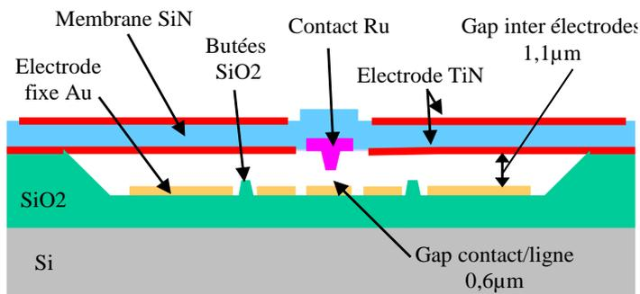
Figure 11 : Schéma en coupe du relais MEMS RF LETI
