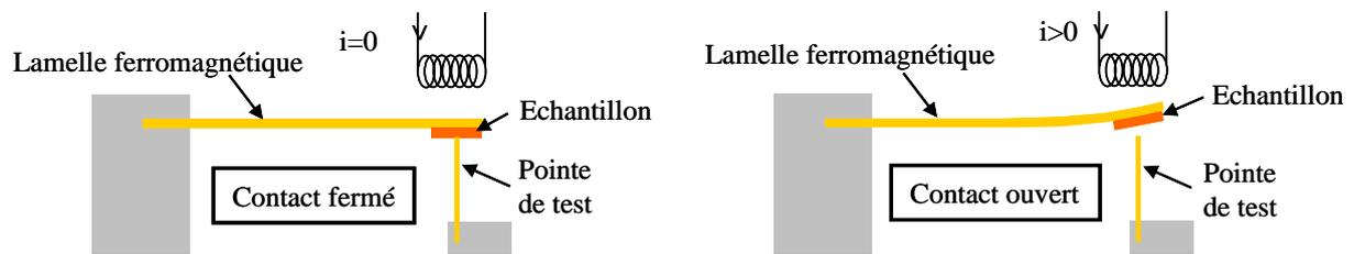
Figure 65 : Principe d'actionnement du banc de cyclage
