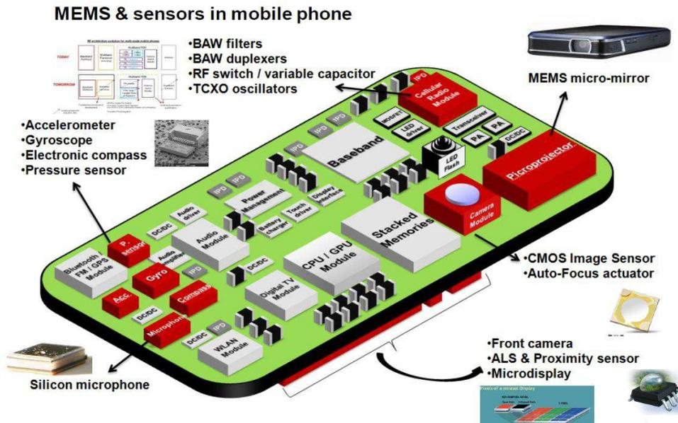
Figure 3 : Composants MEMS dans un téléphone mobile [Perk12]
