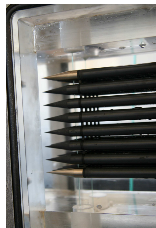
(b) Faisceau de cylindres, détail à l'aval du faisceau.
