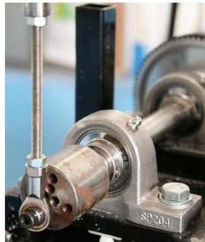
(b) Fixation du bas de la bielle avec excentricité variable pour changer l'amplitude d'oscillation.
