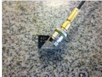
**Figure 33 : Traducteur fixé à un sabot pour une mesure au contact**
