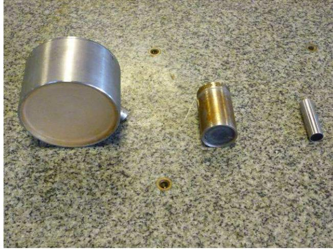
**Figure 51 : Transducteurs utilisés pour les mesures en immersion**
