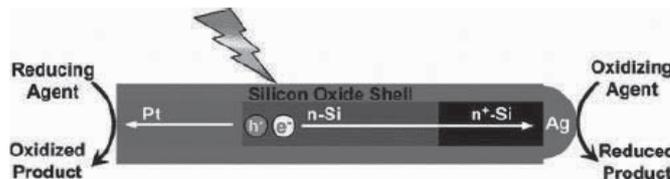
Figure II- 8: Utilisation des nanofils de silicium pour la réalisation de photo-catalyseurs à spectre large<sup>29</sup>.
