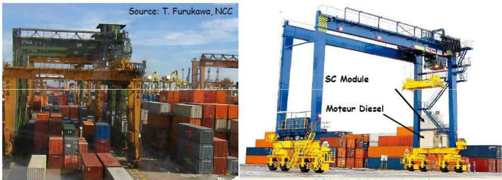
Figure I- 5: Grues aéroportuaires au Japon combinant un moteur diesel et des modules de supercondensateurs<sup>14</sup>.
