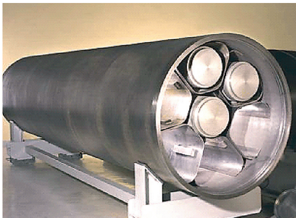
Fig. 145. Démonstrateur « échelle 1 » du conteneur d'entreposage.
