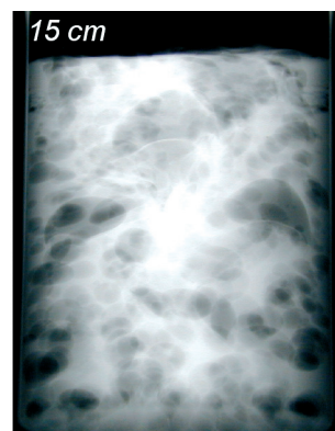
Fig. 88. Coupe radiographique par rayons X d'un enrobé bitume de synthèse soumis à une irradiation externe gamma d'environ 1MGy à 25 °C. Initialement, l'enrobé occupait la moitié de l'éprouvette expérimentale.
