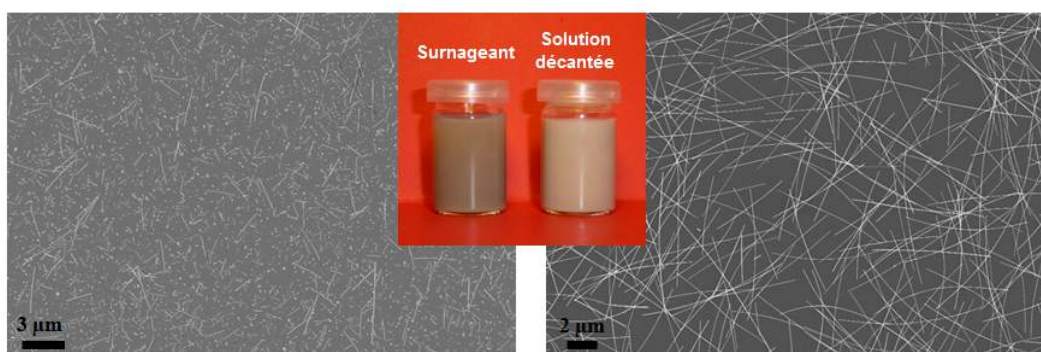
FIGURE 2.19 – À gauche : cliché MEB du surnageant déposé sur PEN. À droite : cliché MEB du « produit décanté », redispersé dans le méthanol et déposé sur PEN. En encart une photographie des deux solutions associées illustrant la différence de couleur.
