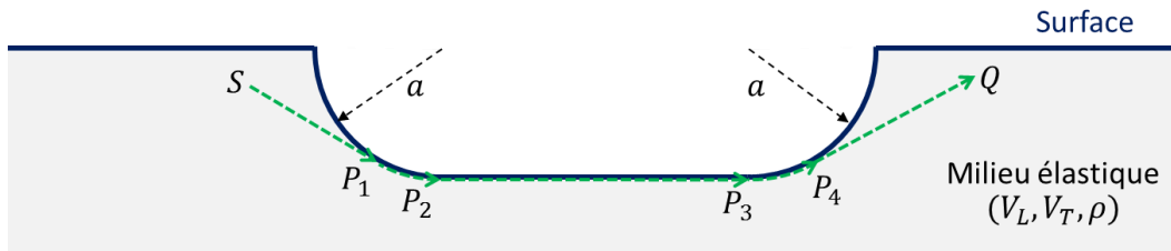
Figure 3.15 : Trajet complet SP_1P_2P_3P_4Q le long d'un affouillement
