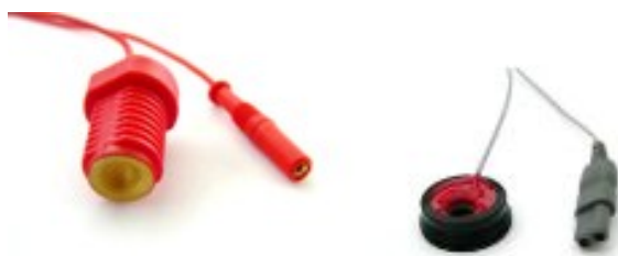
FIGURE 7.2 – Électrodes passives (à gauche) et actives (à droite).
