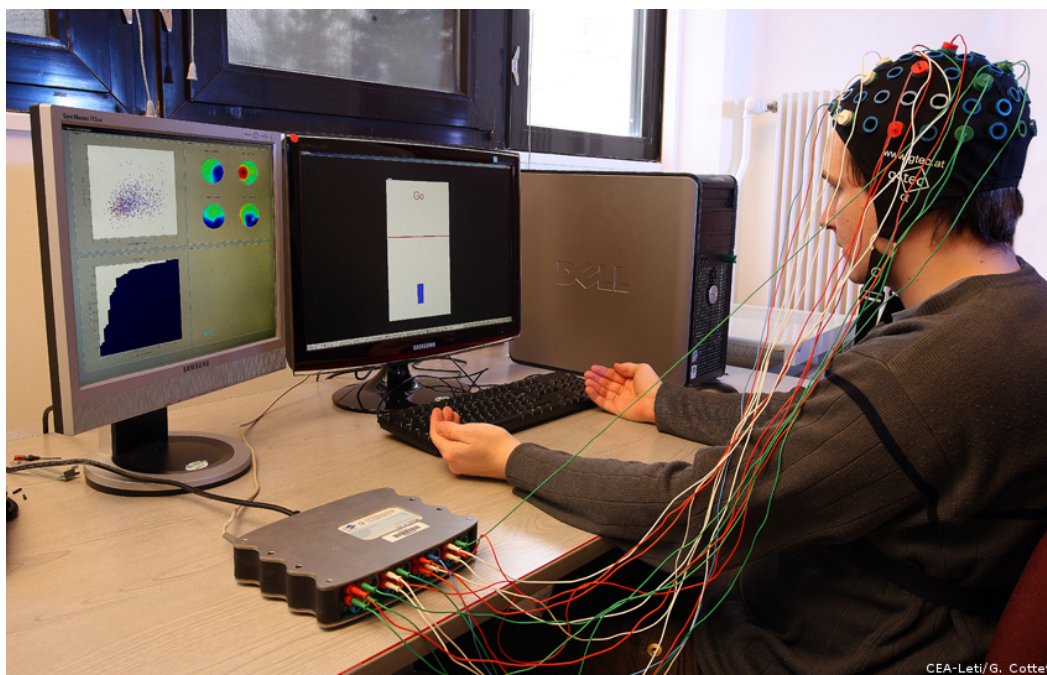
FIGURE 7.3 – Chaîne expérimentale au laboratoire : l'amplificateur g.USBamp, le casque à électrodes passives et l'environnement logiciel avec un écran destiné à l'utilisateur et un écran de contrôle
