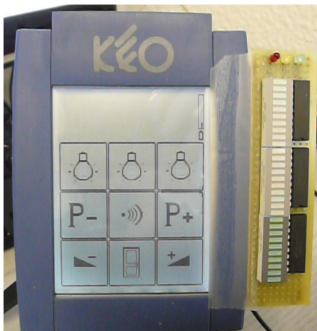
FIGURE 9.4 – Le KEO (à gauche) et la carte d'interface (à droite) affichant le feedback à l'utilisateur et commandant le KEO via un relai REED.
