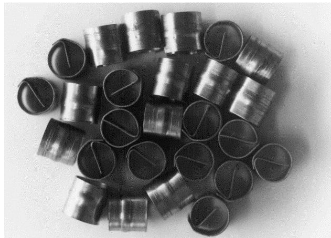
Figure II-11 : Anneaux de Lessing utilisés comme intensificateur thermique dans les MCP [51]
