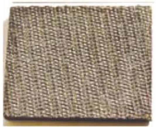
Figure II-16 : MCP associé à du graphite pour faire un matériau composite, (a) [63], (b) [52]
