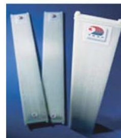
Figure II-33 : Différentes géométries utilisées pour la macro-encapsulation
