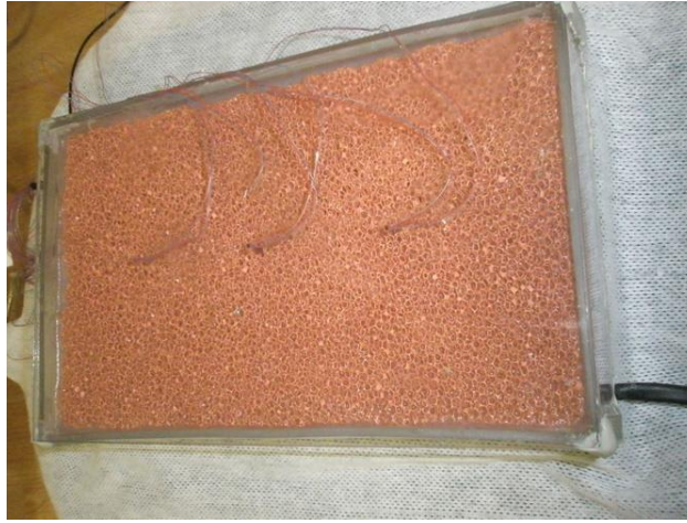
Figure II-14 : Mousse de cuivre à imprégner de MCP [56]
