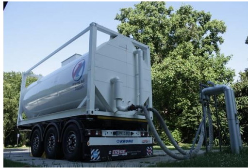
Figure II-3 : Camion-stockeur de la société Latherm [16]
