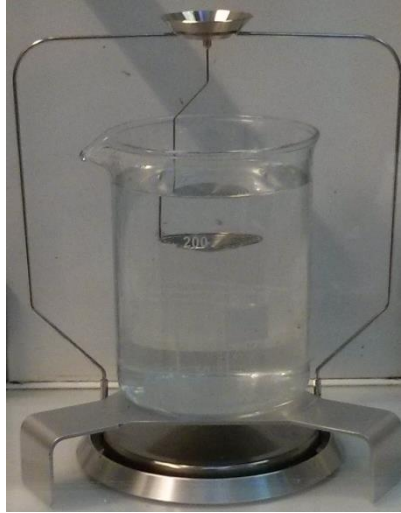
Figure 25 : Montage pour pesée hydrostatique
