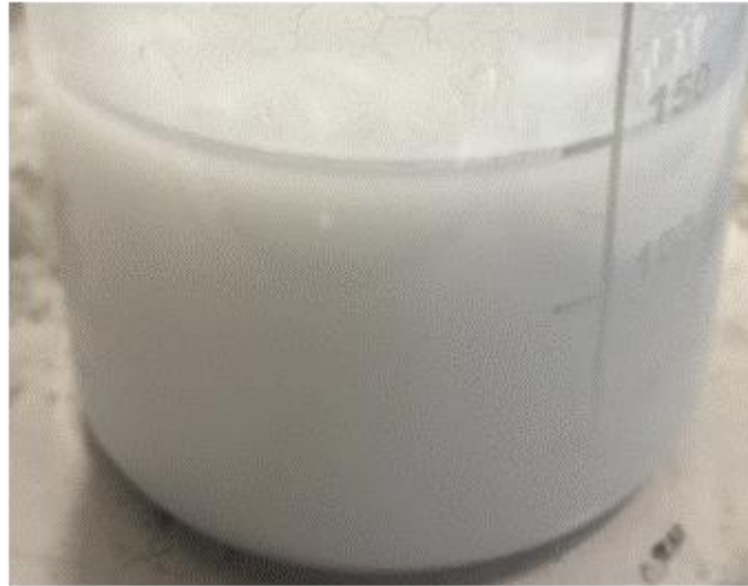
Figure 47 : Gel obtenu après gélification des trois précurseurs mélangés simultanément
