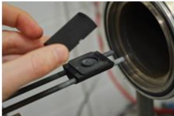
Figure 24 : Suscepteur en carbone du four à induction
