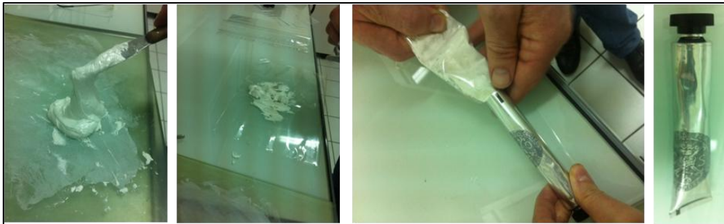
Figure III-5 - Préparation des tubes de peinture : la pâte de pigment est placée dans une poche de plastique pour remplir manuellement le tube, qui est ensuite fermé
