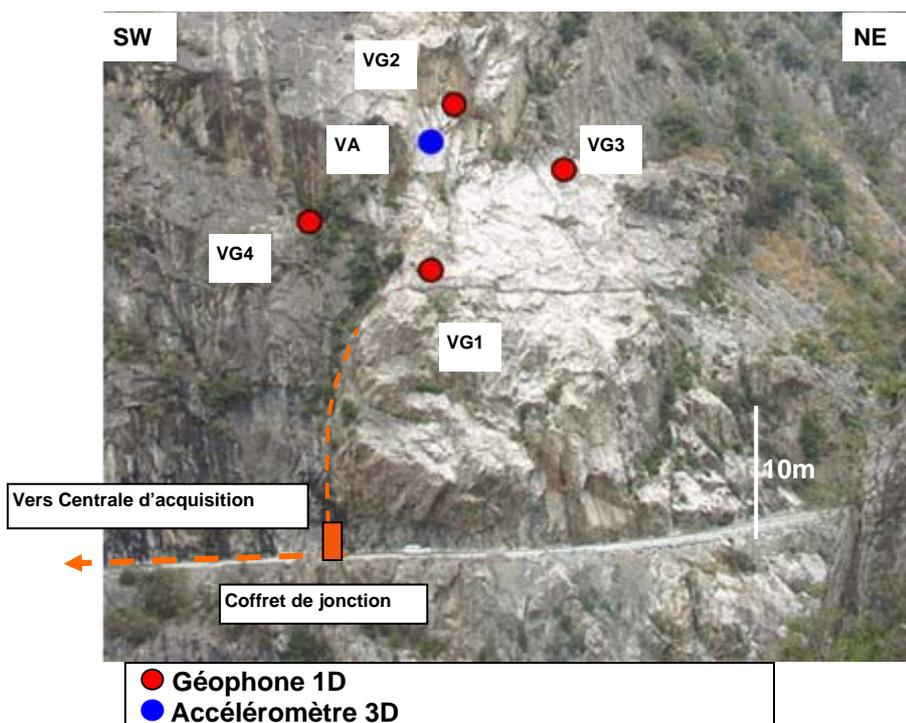
Figure 3. Implantation du réseau microsismique
