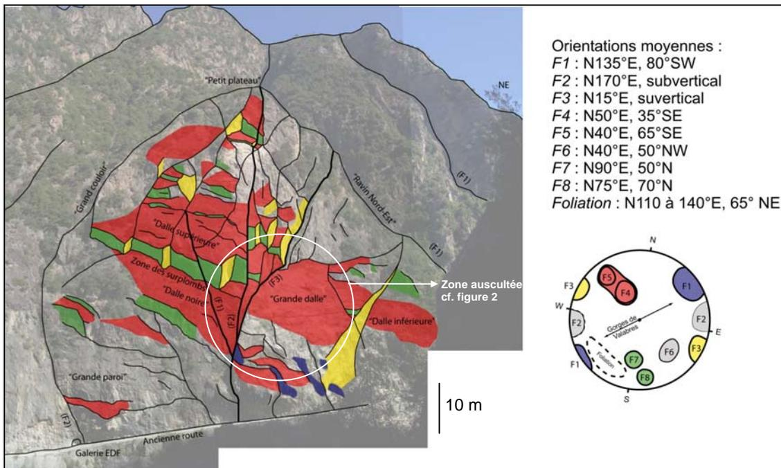
Figure 2. Géométrie et fracturation du versant (Gunzburger, 2004).
