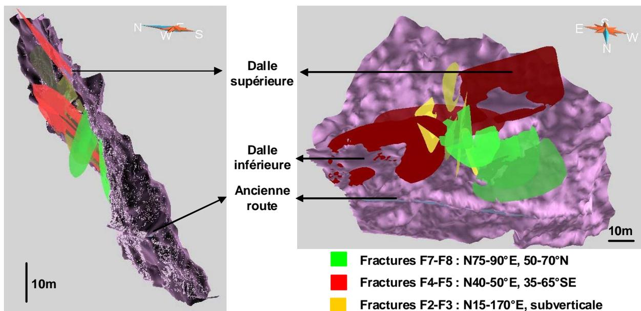
Figure 7. Prolongement du réseau de fractures en profondeur.
