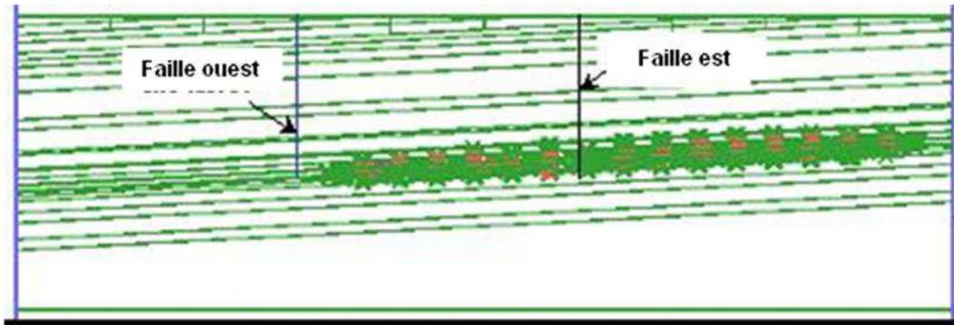
Figure 9 : Stabilité globale de l'exploitation en phase de traçage, peu de points en rupture (en rouge sur le graphique) (phase 1)
