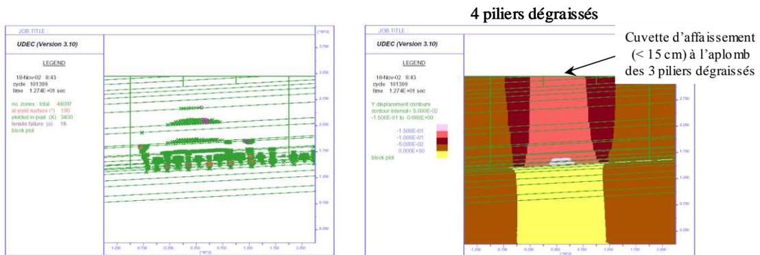
Figure 10 : Développement des points en rupture et des iso-déplacement à l'issue du dégraissage du 4<sup>ème</sup> pilier (phase 2).
