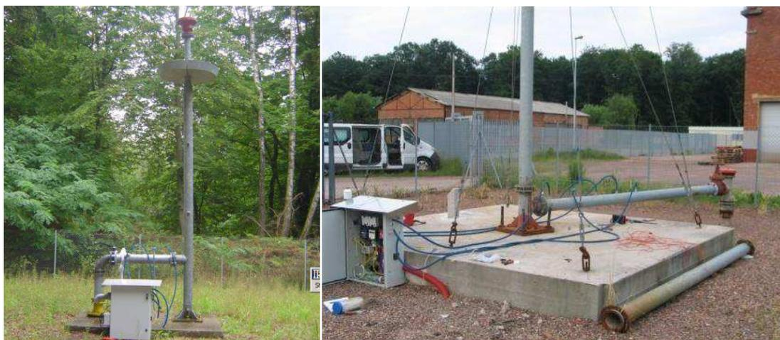
Figure 5 : Instrumentation du sondage SDEC OUEST 1 (g.) et du puits Barrois (d.)
