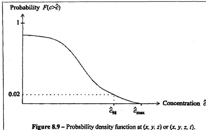
**Figure 6 :** Modèle de fluctuation Fonction de probabilité de dépassement utilisée par ADMS3
