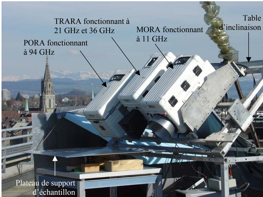
Fig. V.12 & V.13 : Photos des radiomètres MORA, TRARA et PORA installés sur la table d'inclinaison (photo du haut) et ASMUWARA (photo du bas, courtesy Lorenz Martin IAP-University of Bern), durant la campagne de tests sur le toit de l'IAP à Berne. Les échantillons étaient placés sur la plaque métallique de support.
