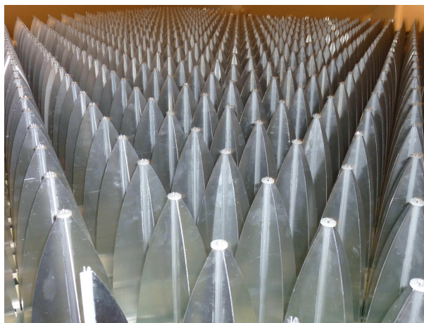
FIGURE 4 – Une tuile composée d'antennes Vivaldi avec commandes intégrées
