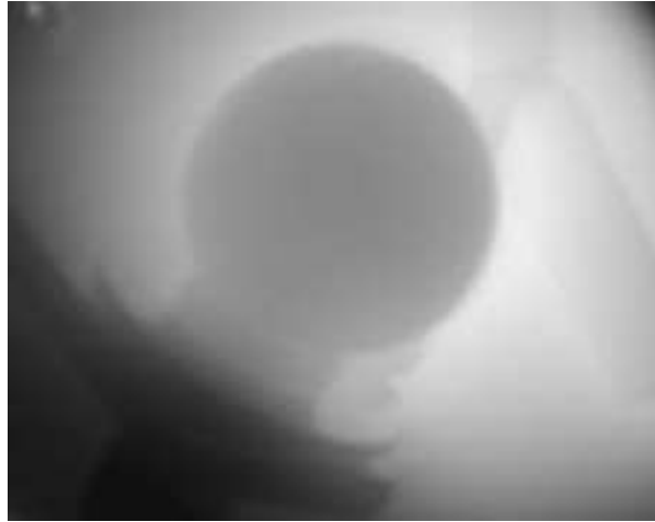
Figure 4.9. : Photographie optique du plasma d'argon créé lors du décapage ionique in situ d'une tête sphérique de prothèse de hanche
