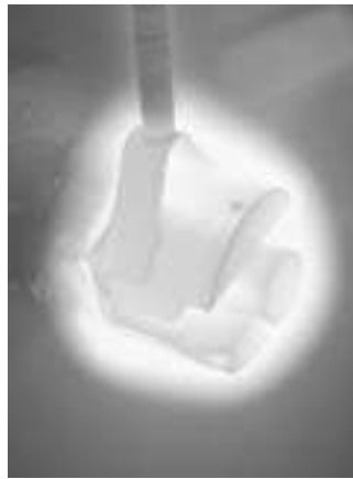
Figure 2.7. : Photographie optique du plasma d'argon créé lors du décapage ionique des substrats en acier inoxydable austénitique 316L
