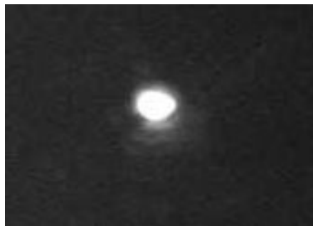
Figure III- 14: Intensité de la lumière à la sortie de la structure hybride, pour un guide de largeur de diffusion de 4\mu\text{m} , et une couche magnéto-optique d'épaisseur 2.6\mu\text{m} ( \lambda = 1550\text{nm} ).
