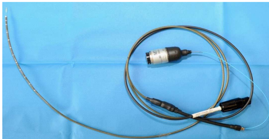
Figure 61 - Sonde Edith avec le capteur de pression MTC qui est introduit par le canal central.
