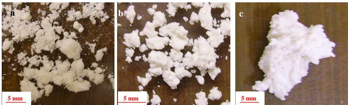
Figure 3. 10. Evolution morphologique du mélange cellulose microcristalline / eau au cours du mouillage, a) w= 70\% , b) w=110\% , c) w=160\%
