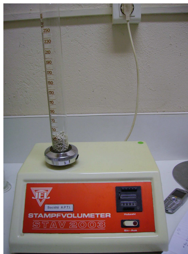
Figure 4. 1. Volumétre de tassage (Stampfvolumeter STAV 2003 JEL)
