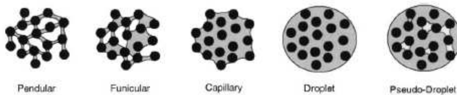
Figure 1. 6. Les différents états de l'eau dans un agglomérat (Newit et Conwey-Jones, 1958)
