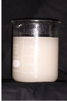
Figure 2.2-5 : Aspect d'un coulis d'hydrates de TBAB
