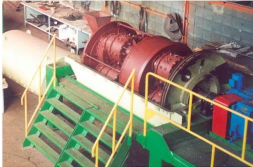
Figure II-7 : Exemple de broyeur planétaire industriel
