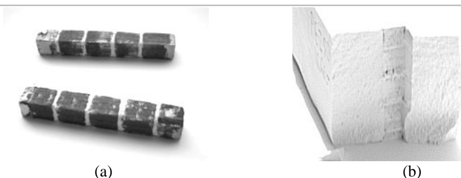
Figure 49 - Après l'essai : (a) échantillon de bois. (b) logement du bois dans l'échantillon de matrice
