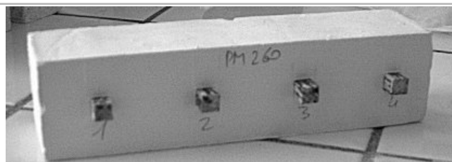
Figure 38 - Une éprouvette de push-out
