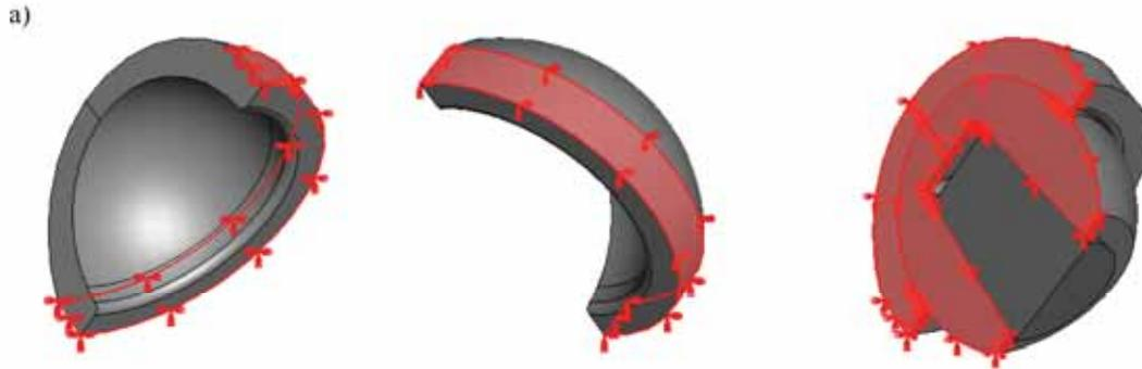
**Figure IV.5** : Conditions aux limites appliquées au modèle. a) Condition d'encastrement de la cupule. Cette dernière est encastree au niveau de sa périphérie, chaque ergot symbolise le blocage du mouvement en translation dans la direction considérée. b) Condition de symétrie par rapport au plan vertical.
