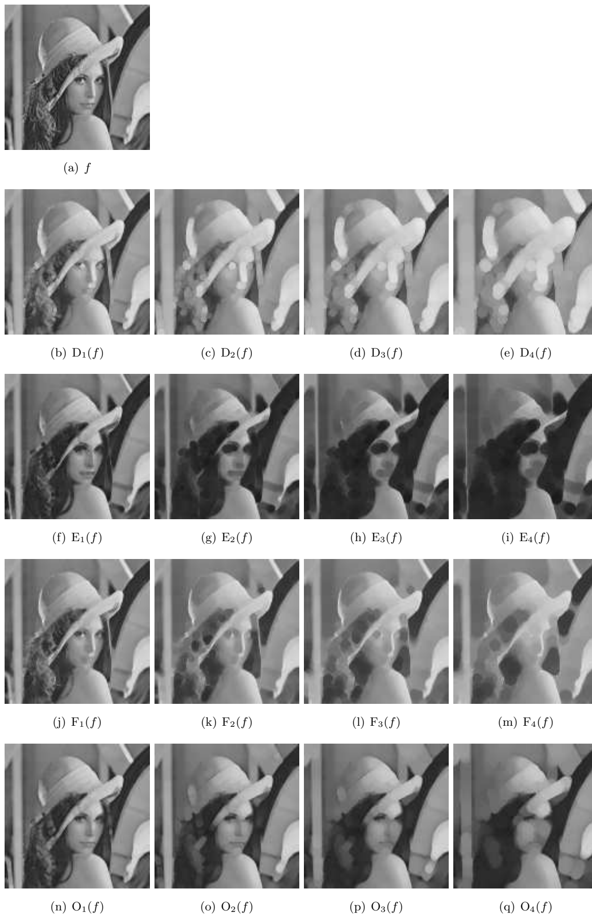
FIGURE 7.5 – Opérateurs morphologiques classiques plats avec une boule de rayon 1, 2, 3 ou 4 pour ES.
