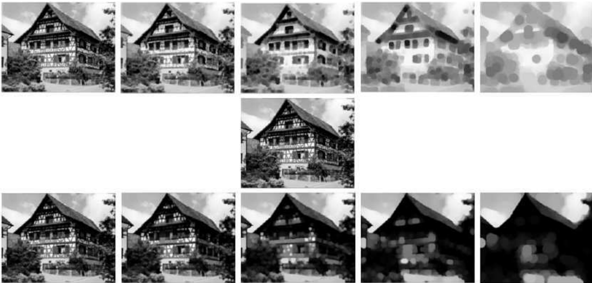
FIGURE 3.9 – Scale-space morphologique par fermetures (ligne du haut)/ouvertures (ligne du bas) de l'image 'chalet' (image centrale).
