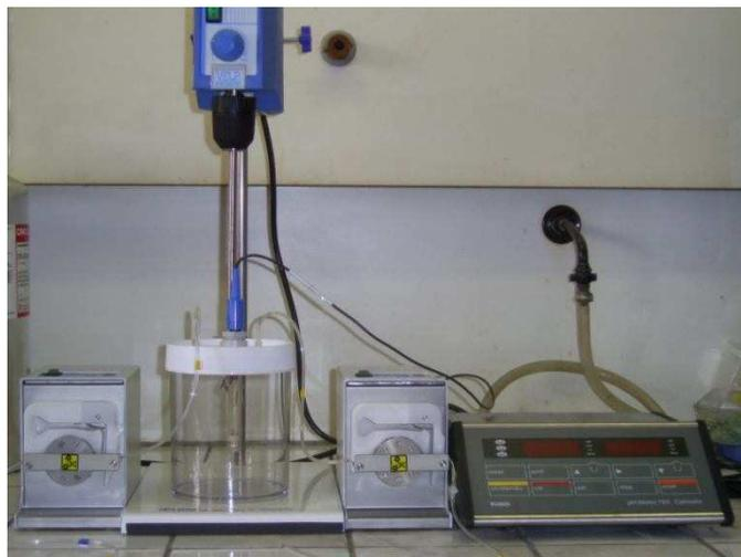
**Figure 17: Illustration du montage de synthèse d'HDL**
