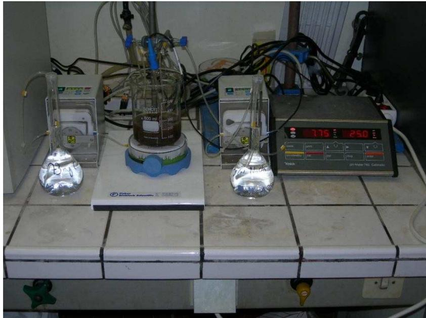
**Figure 24: Montage pour les tests à pH constant**
