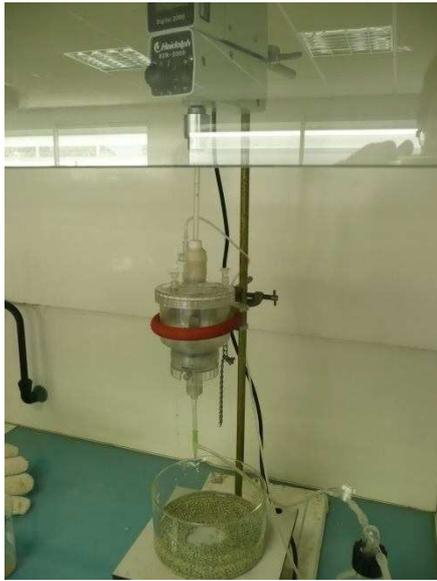
**Figure 88: Pilote d'encapsulation de la boue**
