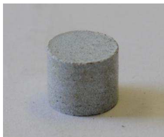
Figure 26. Image du cermet obtenu après pressage à 400 MPa
