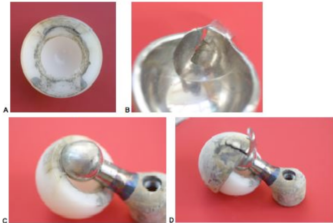
Figure 25 : observation C3 : cotyle tripode et col circulaire modulaire en titane.
