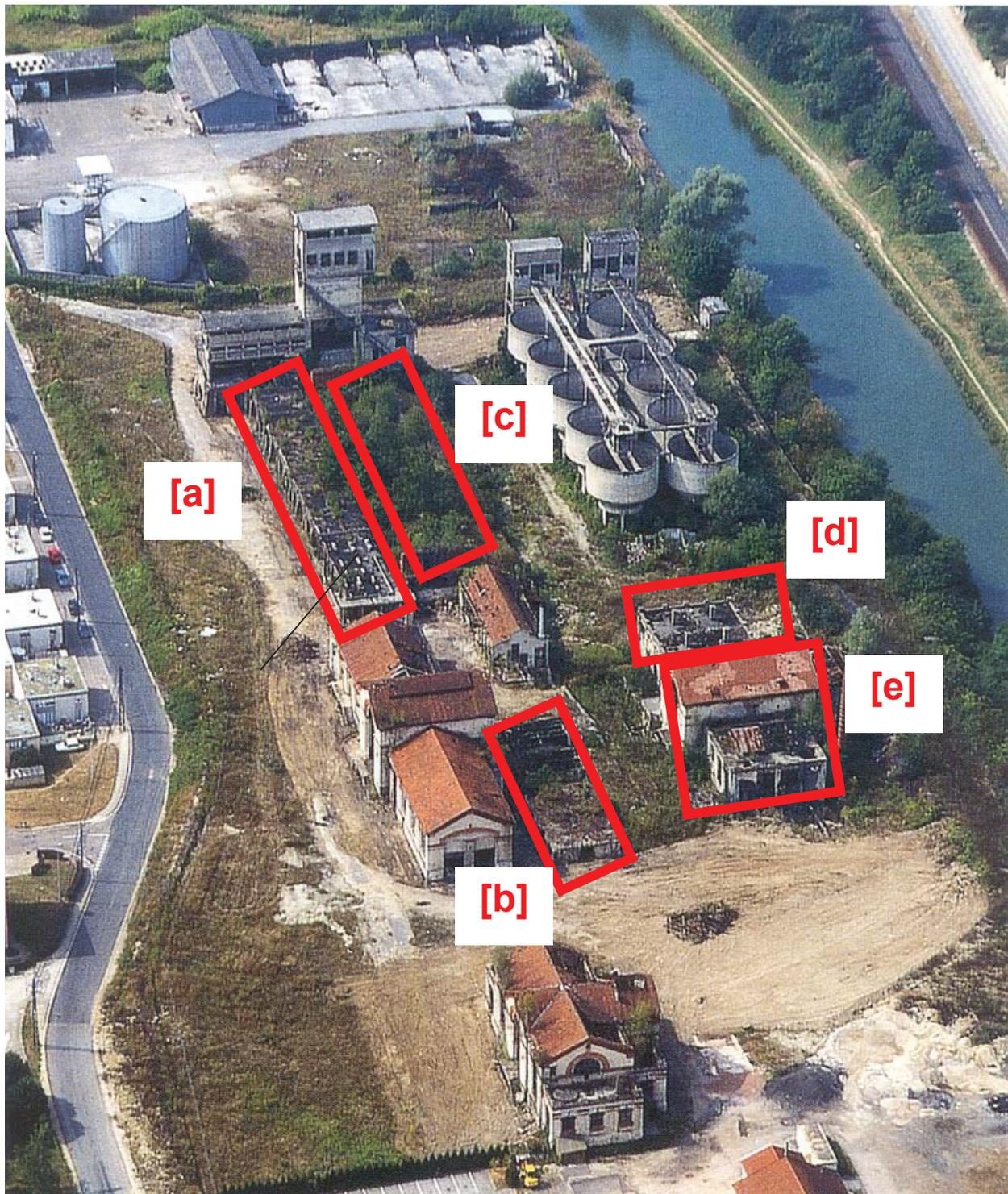
**Figure 8 :** Localisation des ateliers sensibles sur une cokerie (exemple de l'ancienne cokerie de St.-Dizier qui présente une configuration sensiblement identique au site étudié)
