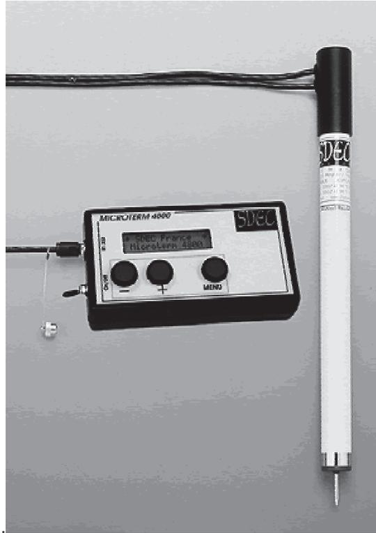
**Figure 50** : Humidimètre capacitif pour les sols HMS 9000 développé par l'Institut National de Recherche Agronomique (INRA) d'Avignon (selon : [www.sdec-france.com/fr/HMS9000.html](http://www.sdec-france.com/fr/HMS9000.html))
