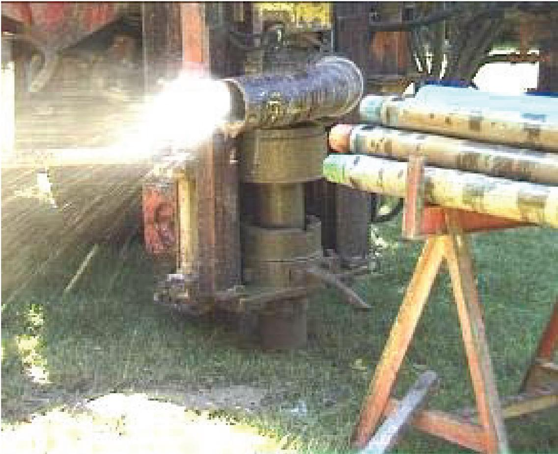
**Figure 103 :** Foration Odex à l'air comprimé
