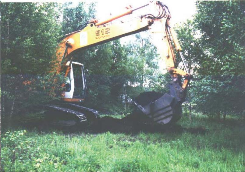
**Photo 2 :** *Excavation de fosses de prélèvements pour l'échantillonnage.*
