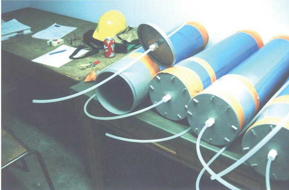
Figure 67 : Cannes de prélèvement de gaz
