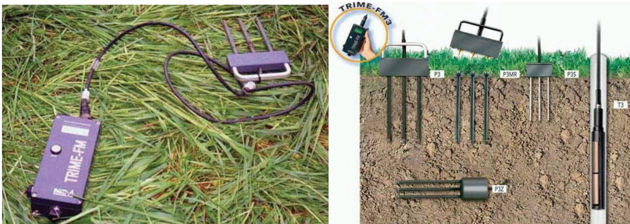
Figure 49 : Sonde TDR : appareil de mesure et exemples de sondes Trime-FM3 (d'après IMKO : <http://www.imko.de>)
