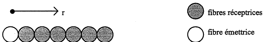
Figure cg1 : schéma d'un nouveau capteur pour la détermination d'une distribution granulométrique
