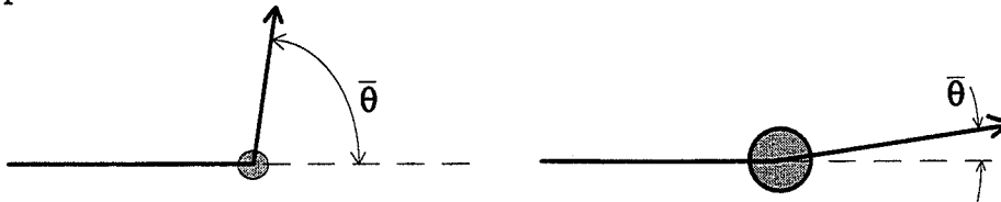
Figure 1.2.5 : comparaison entre les angles moyens de diffusion d'une petite et d'une grande particule
