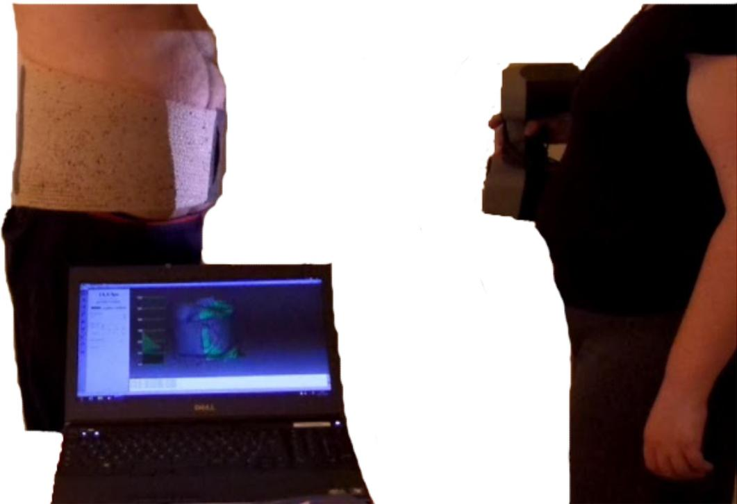
Figure 5.2 – Illustration de la mesure à l’aide d’un topographe optique 3D sur le tronc humain
