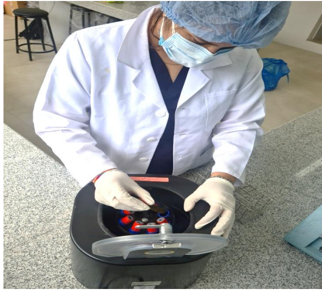
Foto 7. Colocación de las muestras en la centrifugadora
