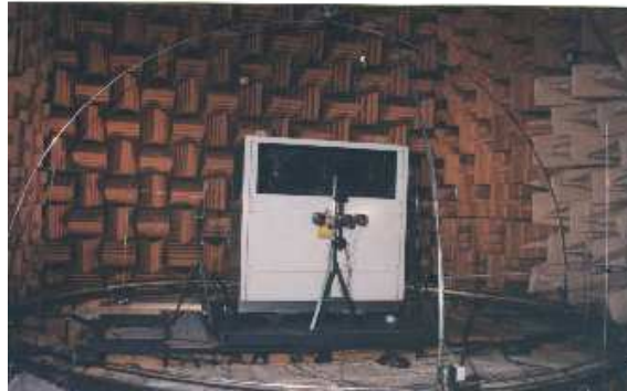
FIG. 3.11 – Un transformateur de puissance en chambre anéchoïque
