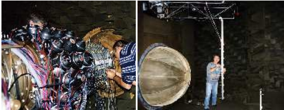
FIG. 3.7 – Le banc d’essai du bruit de soufflante
