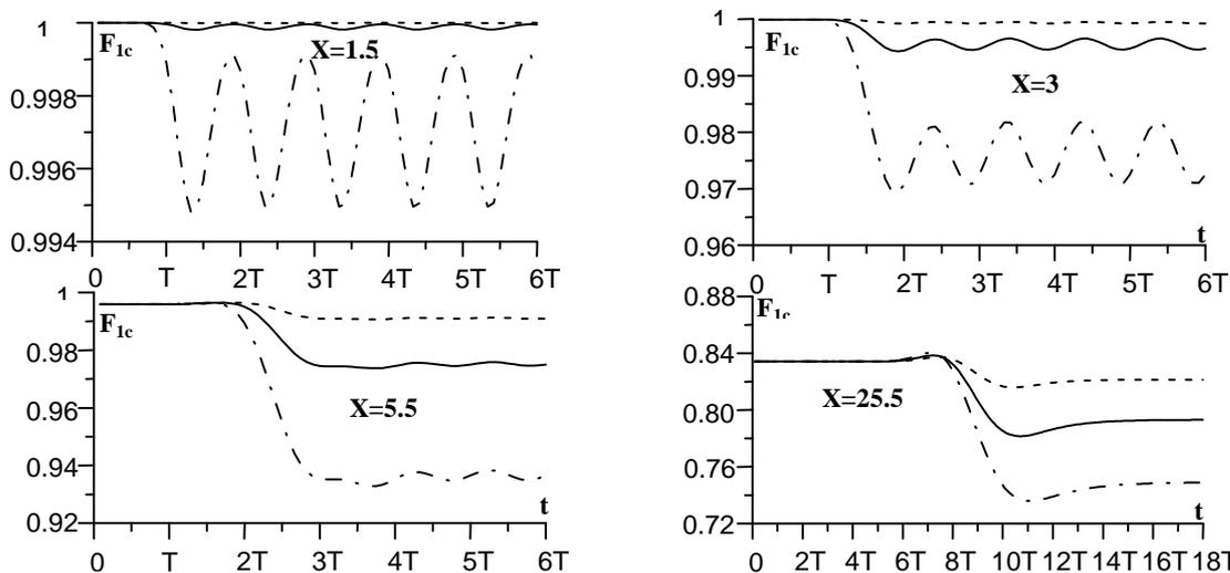
**Figure 2 :** Evolution temporelle de la fraction massique au centre pour  $u_{01}=0.711\text{m/s}$ ,  $b=0.01\text{m}$ ,  $St=0.5$  et -----  $A= 15\%$  ———  $A= 30\%$  -.-.-.-  $A= 50\%$
